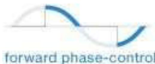
*Figura 7:* Señal de salida para luminarias Incandescentes, Fuente Manual Lutron
