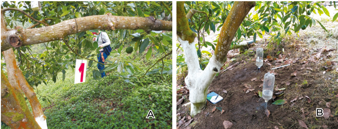
Figura 10. A. Árboles marcados en las subparcelas con y sin fertirriego. B. Pruebas con botellas Mariotte, medición del área de humedecimiento y determinación del número de goteros por árbol
