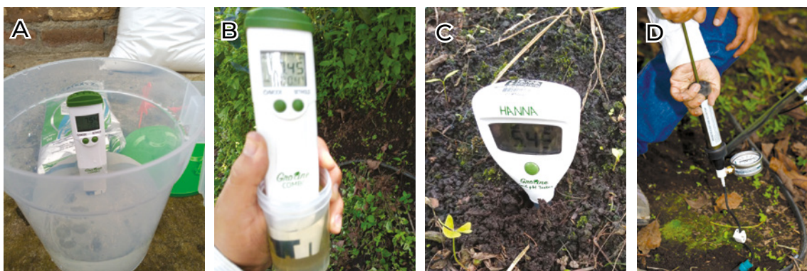
Figura 21. Medición de pH y conductividad eléctrica en: A. Solución de los tanques de preparación. B. Salida de los emisores. C. Suelo del área de riego. D. Solución extraída del suelo mediante sondas de succión
