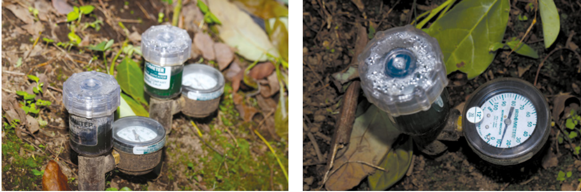
Figura 18. Tensiómetros a 15 y 30 cm de profundidad
