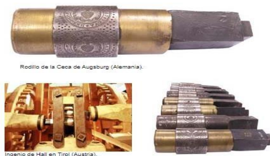
Figura 4. Rodillos utilizados para el acuñado de monedas.
