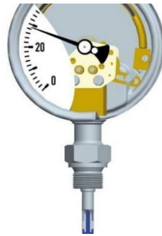
Figura 67. Termómetro de dilatación de Líquido
