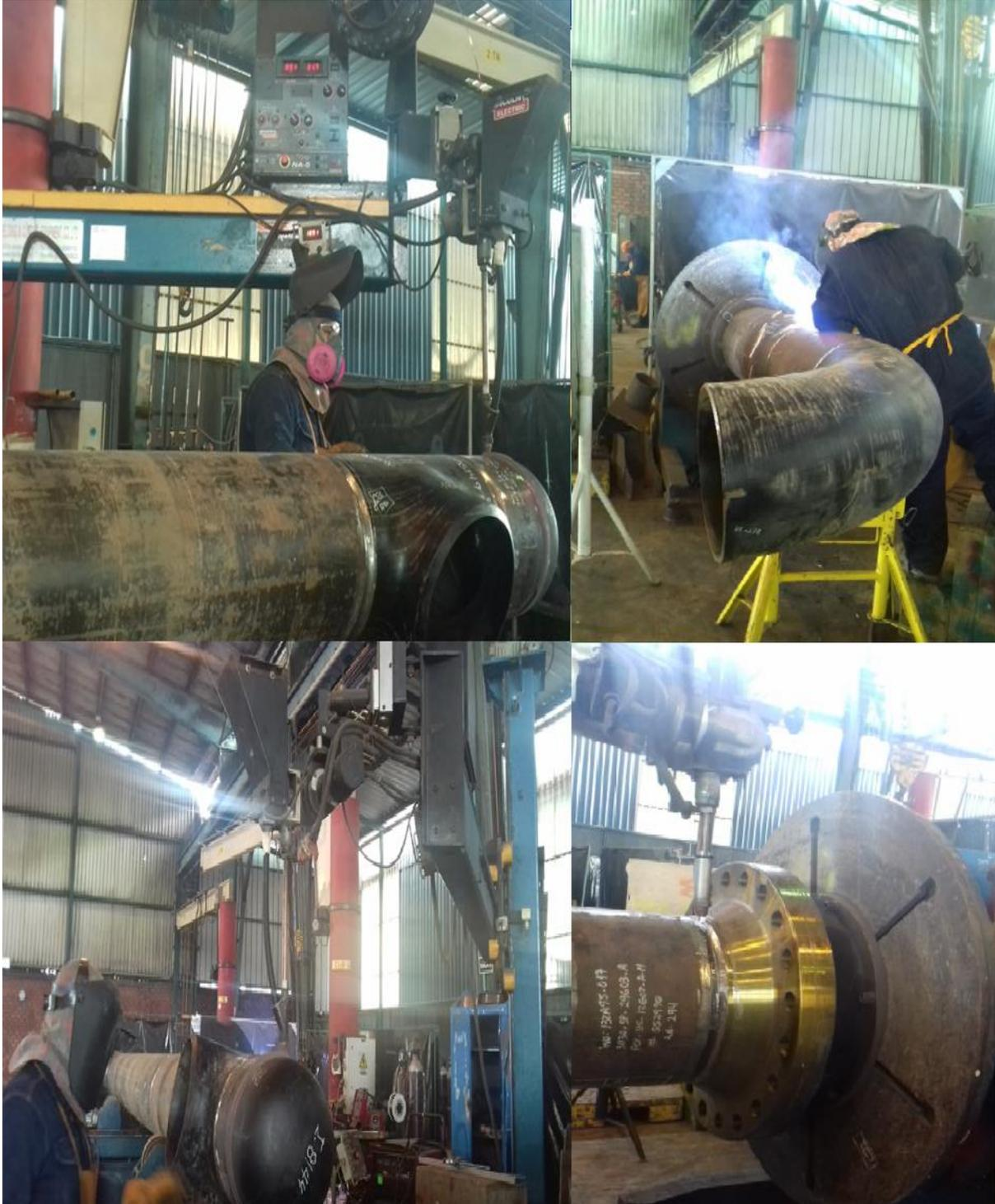
Soldadura Rotada: Le facilita el trabajo al soldador y aumenta su productividad en un 25 % con este proceso de soldadura, se realizo toma de tiempos con el nuevo procedimiento tanto para Caldereros/Armadores y soldadores.
