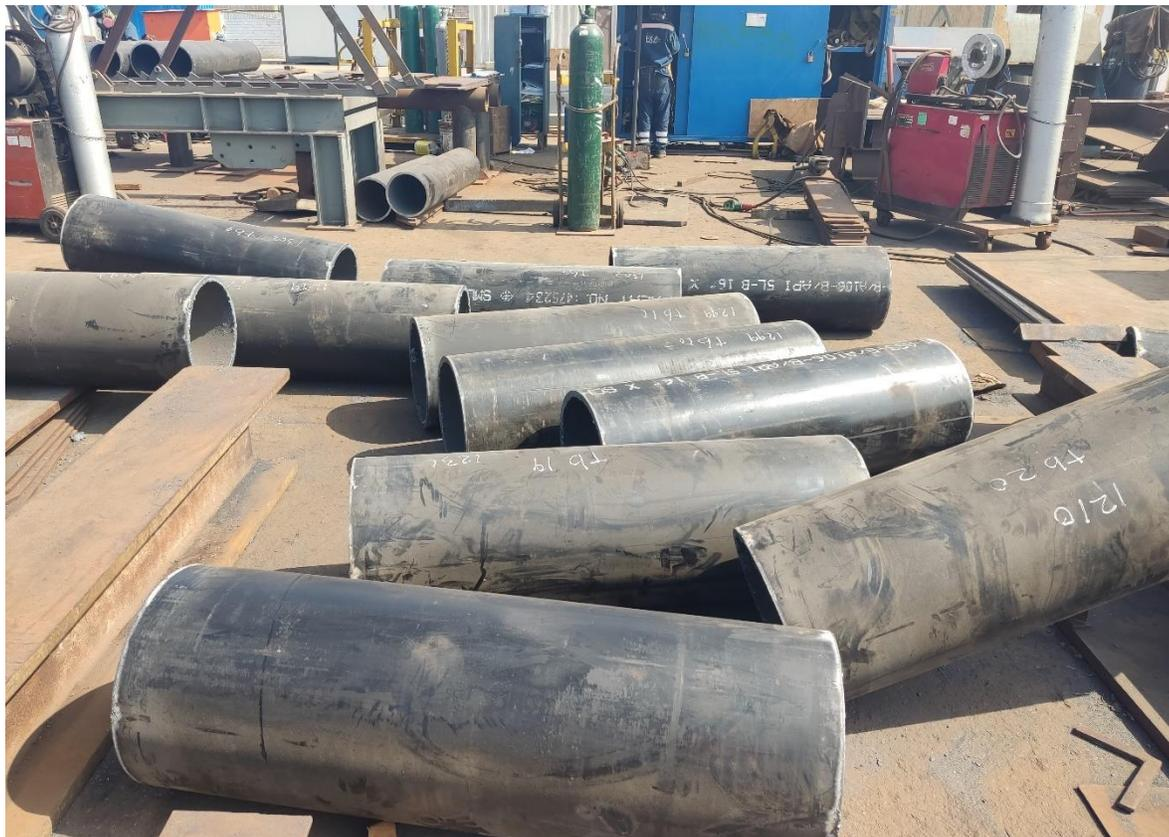
6. Línea de producción. – Este es el área principal de los procesos en mención, en esta área se encarga de la fabricación de los spools donde se divide en 2 partes el armado y soldeo donde los operadores de puente grúa distribuyen las tuberías y accesorios mediante un puente grúa instalado en las líneas de producción y se entrega los elementos en cada estación mediante listas de trabajo junto a los planos isométricos de fabricación.
