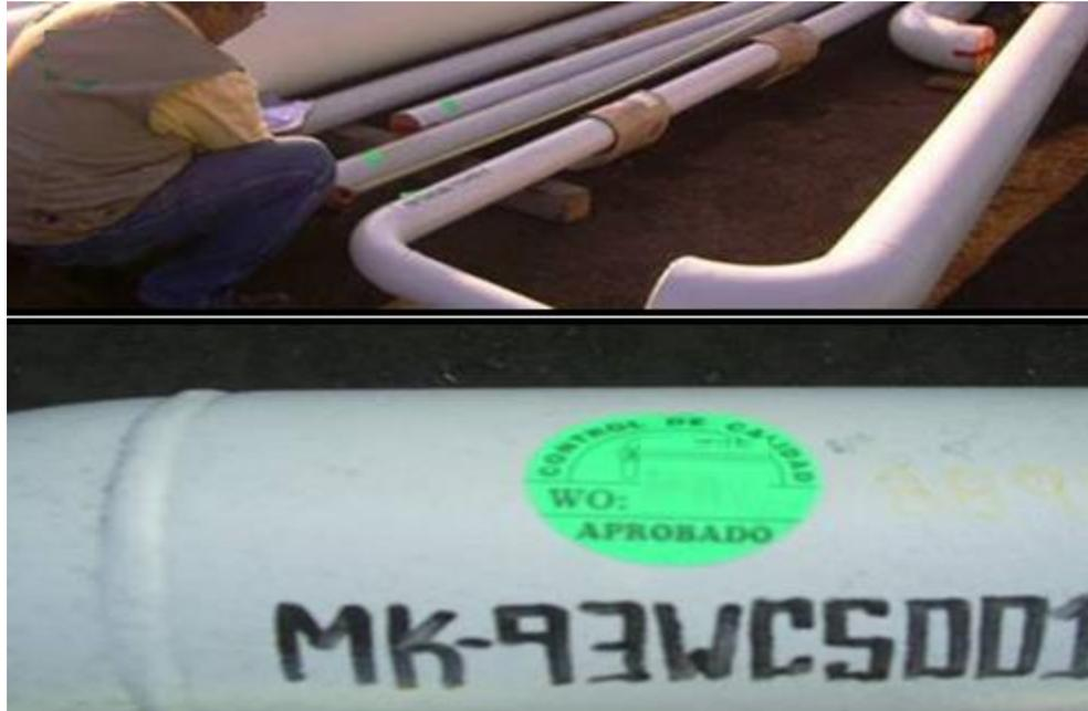
8. Control de Calidad (QC). - QC está involucrado en todos los procesos productivos, desde almacenaje hasta despacho, con inspecciones por muestreo, en las juntas soldadas si se tiene una inspección al 100% debido a que el alcance del proyecto se definió de esa manera. Se detallan los procesos que se aplican para dar certificación que los spools se inspeccionan con requerimientos específicos:
