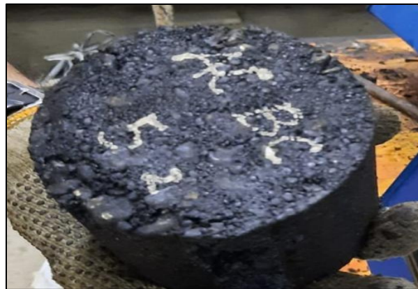
Gambar 4. Spesimen campuran aspal AC-BC
