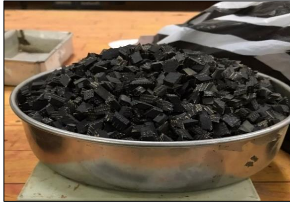
Gambar 1. Limbah ban luar kendaraan yang sudah dipotong sesuai ukuran saringan
