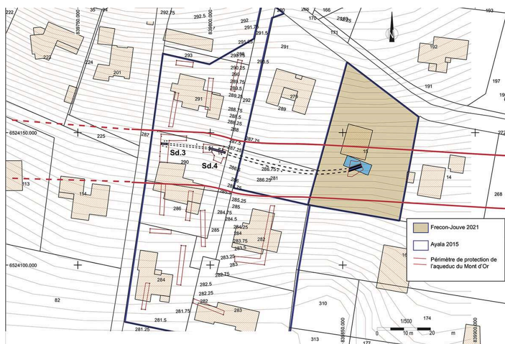
Fig. 3 – Restitution du tracé de l'ouvrage sur le canevas des courbes de niveau avec la projection de la zone de protection de l'aqueduc
