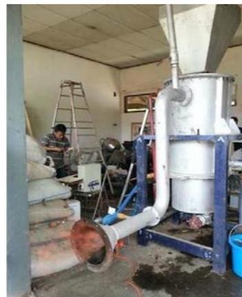
**Gambar 4.3** Gasifier Mini 30kg
