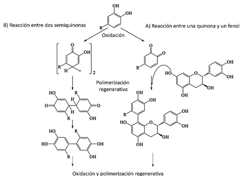
Figura I.10. Oxidación y polimerización regenerativa. A) Regeneración de oligómeros por reacción entre una quinona y un compuesto fenólico. B) Regeneración de oligómeros por reacción entre dos semiquinonas (Adaptado de Li y Duan, 2019).
