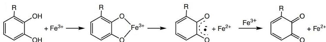
Figura I.7. Oxidación de los compuestos fenólicos por Fe (III) (Danilewicz, 2007).
