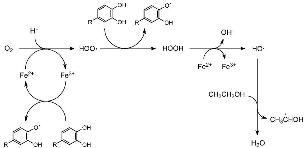
Figura I.4. Mecanismos de oxidación química en vino (Kreitman et al., 2013).
