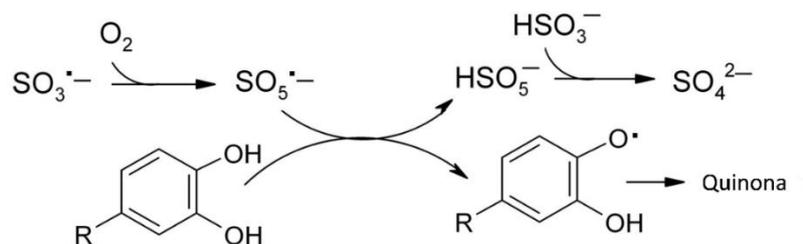
Figura I.8. Oxidación de los compuestos fenólicos por el radical peroxomonosulfato ( $\text{SO}_5^{\bullet-}$ ) (Danilewicz, 2007).
