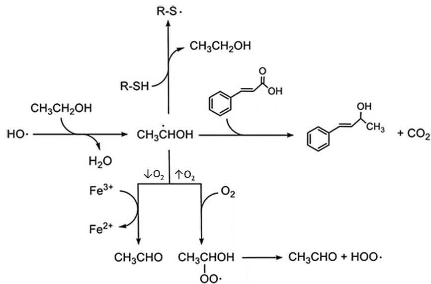
Figura I.13. Formación y mecanismo de acción del radical 1-hidroxietilo (Adaptado de Kreitman et al., 2013).
