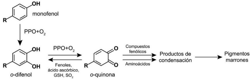
Figura I.1. Oxidación enzimática (Adaptado de Li et al., 2008).
