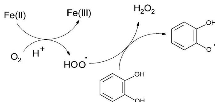
Figura I.6. Oxidación de los compuestos fenólicos por el radical hidroperoxilo ( $\text{HOO}^\bullet$ ) (Adaptado de Danilewicz, 2014).
