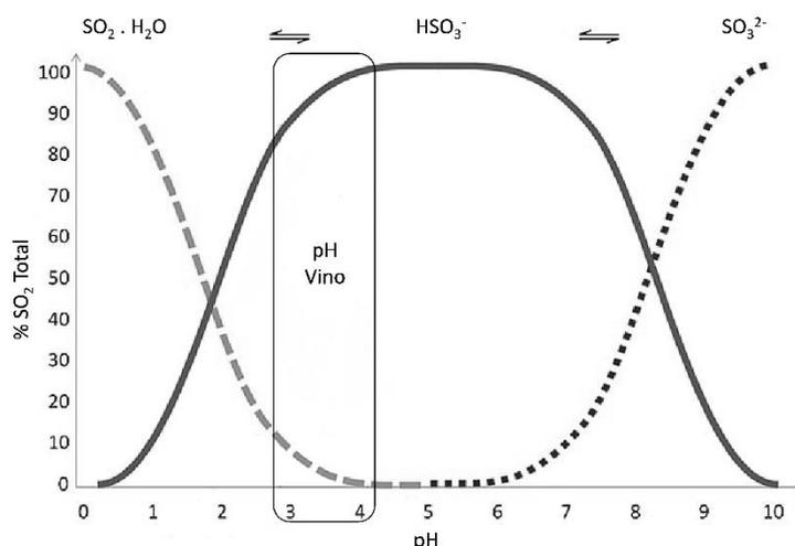
Figura I.18. Formas químicas del SO<sub>2</sub> en función del pH (Adaptado de Divol et al., 2012).
