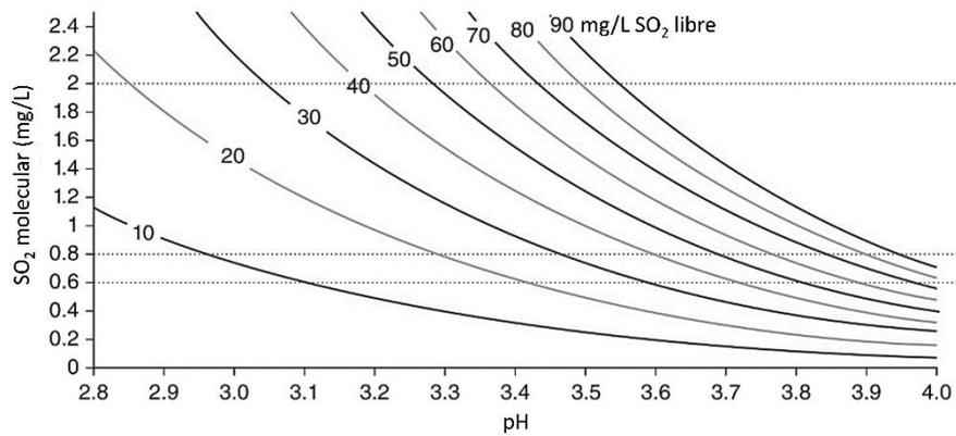
Figura I.19. Curvas de isoconcentración de  $\text{SO}_2$  molecular en función del pH para diferentes concentraciones de  $\text{SO}_2$  libre, determinadas a partir de la ecuación de Henderson-Hasselbalch (Waterhouse, 2016).
