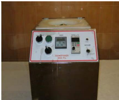
Figura 3.30. Spinner SMA-SPINNER 6000 PRO empleado para la preparación de las películas poliméricas.
