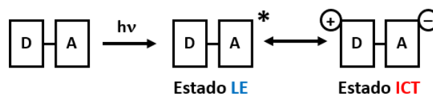
Figura 3.15. Representación esquemática de los estados LE e ICT al producirse la excitación de las moléculas.
