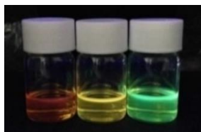
Figura 3.16. Fotografías de luminiscencia de los derivados 62a , 62b y 62c (de izquierda a derecha) tras la excitación a 365 nm.
