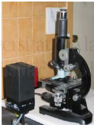
Figura 3.31. Microscopio interferométrico utilizado para medir los espesores de los films poliméricos.
