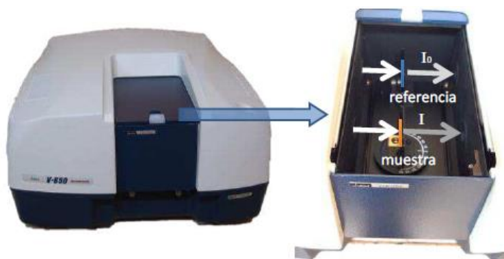
Figura 3.32. Espectrofotómetro Jasco V-650 empleado para las medidas de absorción de las películas poliméricas.
