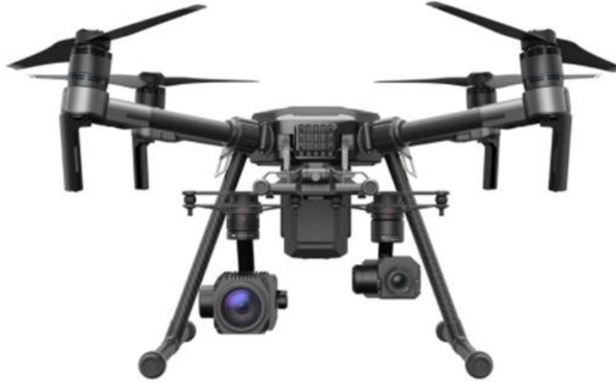
Figura 2. Dron DJI MATRICE 210 Tomada de Grupo Acre – Instrumentos de topografía y medición
