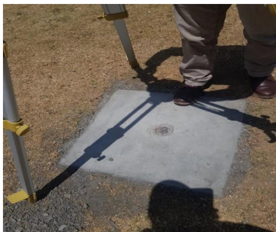
Figura 4. Hito de concreto como punto de control Tomada de Hinostraza
