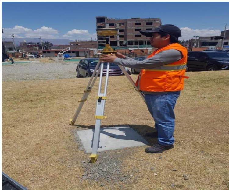
○ Figura 5. Verificación y nivelación del GPS diferencial Tomada de Hinostroza
