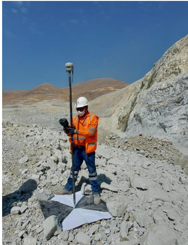
Figura 20. Colocación de puntos georeferenciales
