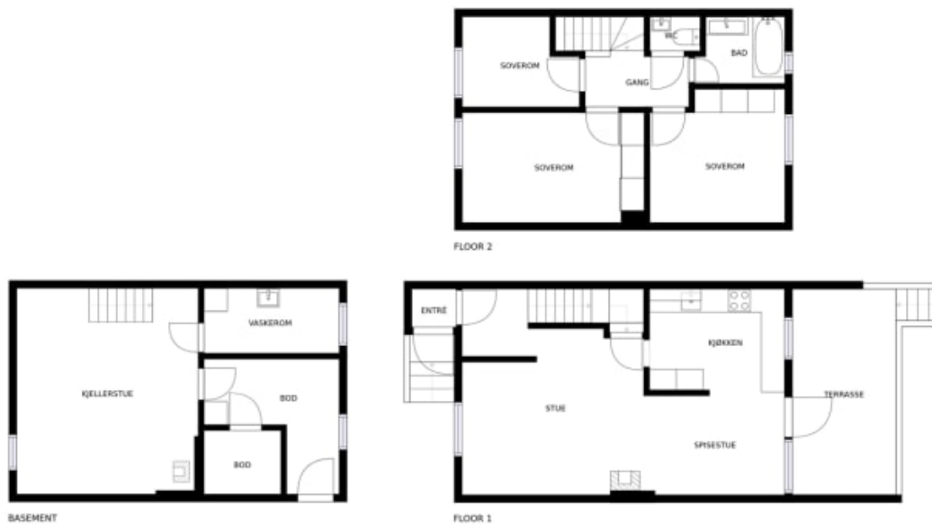
Figur 6.2.2 Planløsning av rekkehus i et borettslag i Kongsvinger (eksempel 1 og 3). Rekkehuset har tre soverom i 2. etasje og mulighet for én eller to ekstra sengeplasser i kjelleretasjen. Slik huset framstår ved salg, har det 4–5 sengeplasser og egner seg for en familie med 3–4 barn. Illustrasjonen er funnet i boligannonse på Finn.
