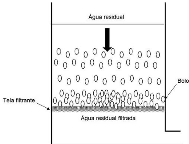
À medida que a filtração decorre, a porosidade da tela diminui, devido à acumulação de partículas em suspensão, aumentando a perda de carga. A perda de carga oferecida pela tela limpa varia com a idade do filtro e com o número de lavagens, sendo geralmente inferior à perda de carga devida ao bolo.
