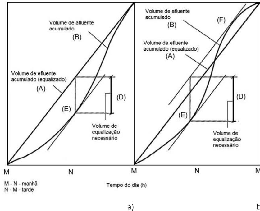
Após a determinação do volume da bacia e do instante em que teoricamente a bacia se encontra vazia, é possível realizar a determinação de carga poluente equalizada, geralmente em termos de  $CBO_5$ .
