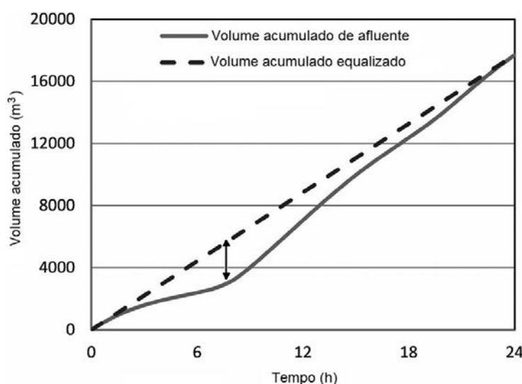
O volume da bacia de equalização é determinado pela distância vertical entre o ponto de tangência da curva do volume acumulado afluyente e a curva do volume acumulado de efluyente equalizado (Figura 7.7.1), ou seja cerca de  $2\,732 \text{ m}^3$ .
