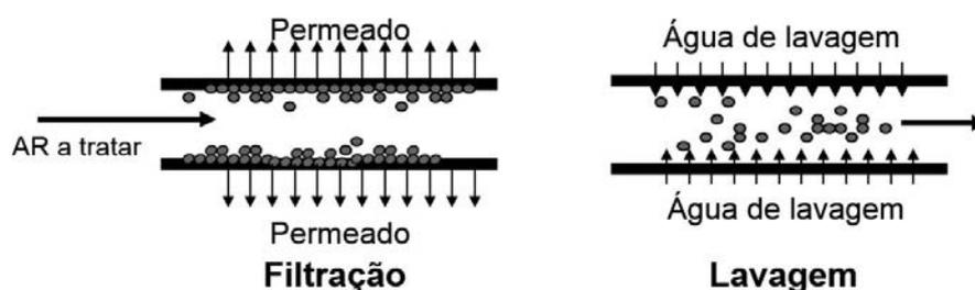
Para minimizar a perda de filtrado e otimizar a lavagem em contracorrente é necessário controlar a pressão aplicada na inversão do fluxo, coadjuvando, por vezes, com a utilização de ar e/ou desinfetante (e.g. cloro) dissolvido sob pressão na água de lavagem, ajudando assim a remover os sólidos, a inativar microrganismos e a controlar a bio-incrustação.
