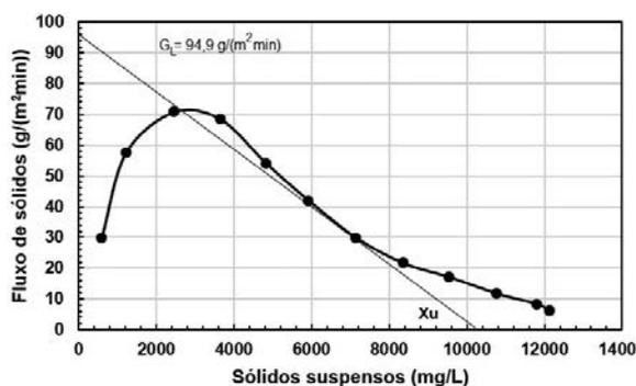
Da Figura 11.7.8 determina-se o valor de  $X_u' = 10\,500 \text{ mg/L}$  e o  $Q_L$  pelas expressões do balanço de massa:
