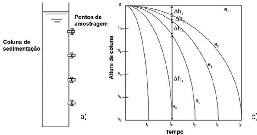
Sendo  $H = h_5$  a altura da coluna de sedimentação (e do decantador), a partir da Figura IV.1b) determina-se o tempo que as partículas demoram a percorrer  $h_5$  para cada percentagem de remoção.
