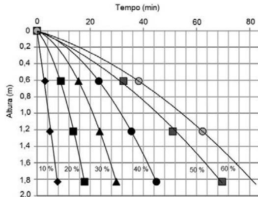
3.º passo – determinação das remoções globais em função do tempo de retenção
