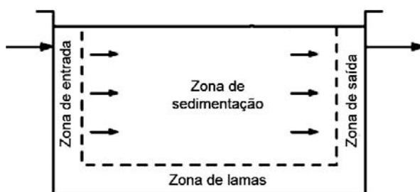
Para que as partículas sejam separadas da água é necessário que o tempo de retenção das AR no tanque de sedimentação seja suficiente para que a trajetória percorrida pela partícula, na sua queda gravítica, assegure que a partícula atinja o fundo do tanque. Essa trajetória difere consoante a forma do sedimentador, como representado na Figura 9.5.
