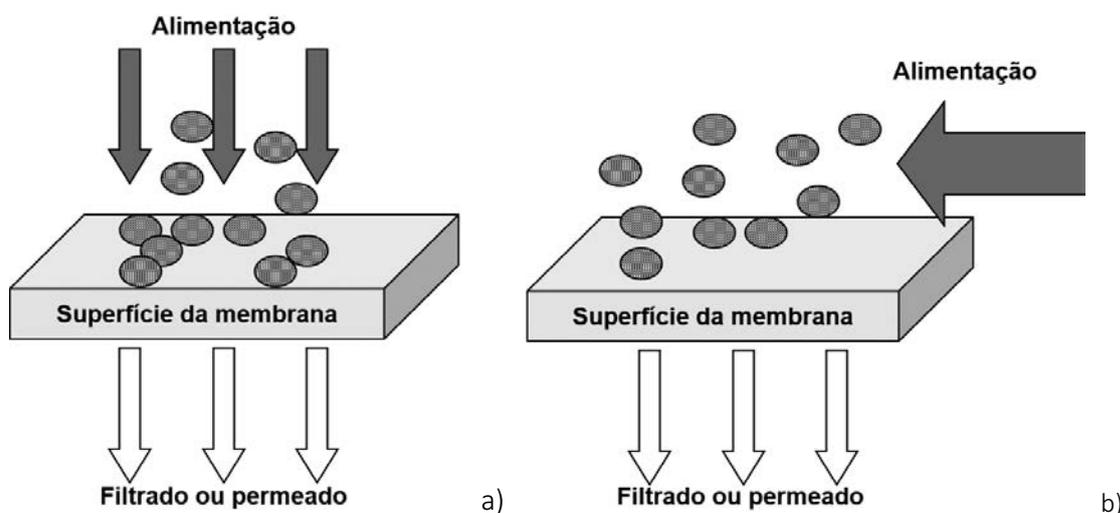
No caso da alimentação perpendicular, não há saída do concentrado durante a operação da membrana, o qual só é removido aquando da lavagem (ver 15.6.1.3). No caso da alimentação tangencial, o concentrado sai continuamente, o que tem a vantagem de aumentar o tempo de operação da membrana, permitindo o funcionamento mesmo com AR mais concentradas nos poluentes a separar.
