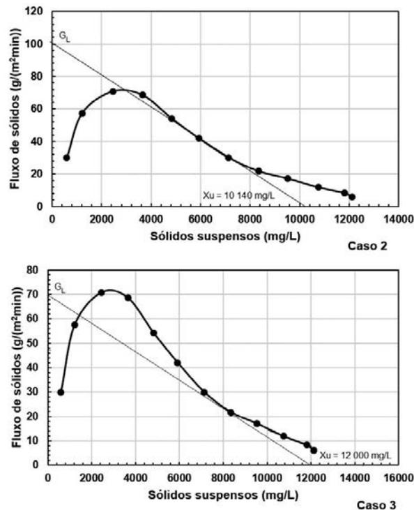
Da Figura 11.7.9 determina-se o fluxo limite para os dois casos.
