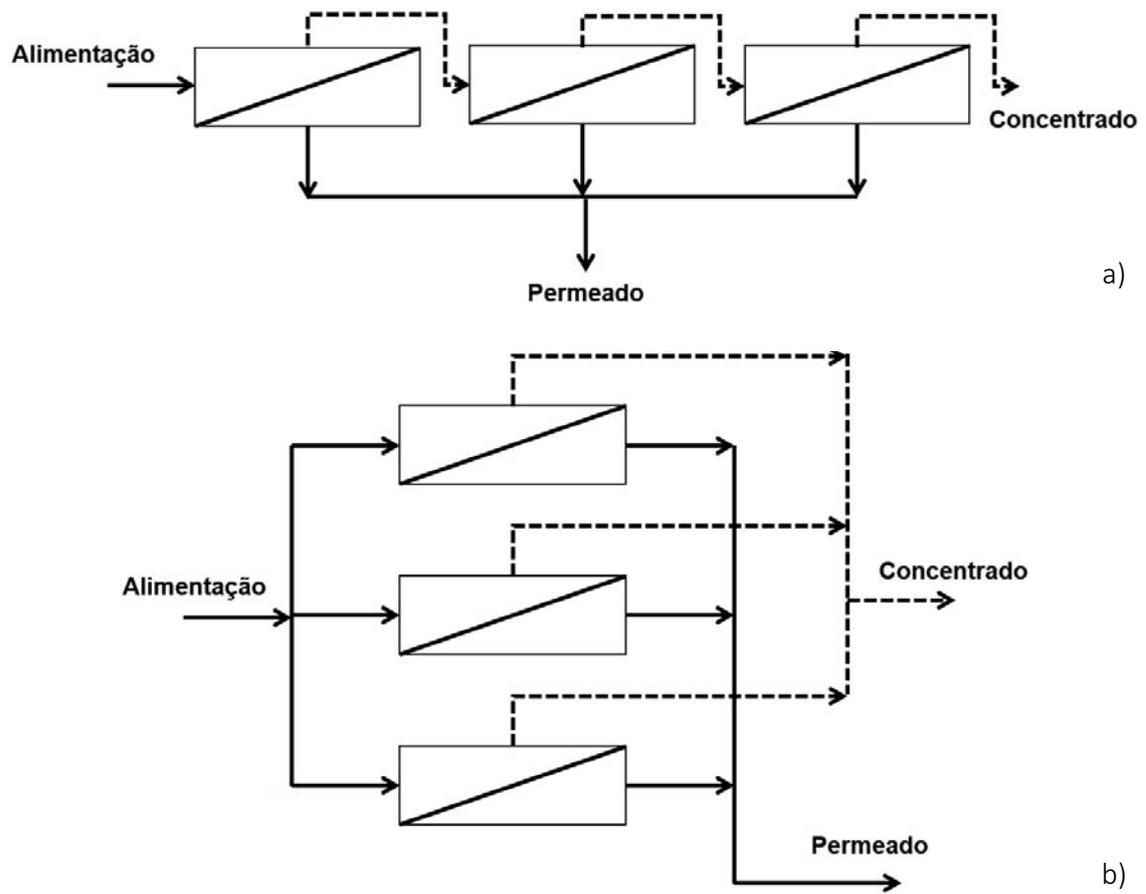
**Figura 15.12** Associação de módulos de membranas em árvore
