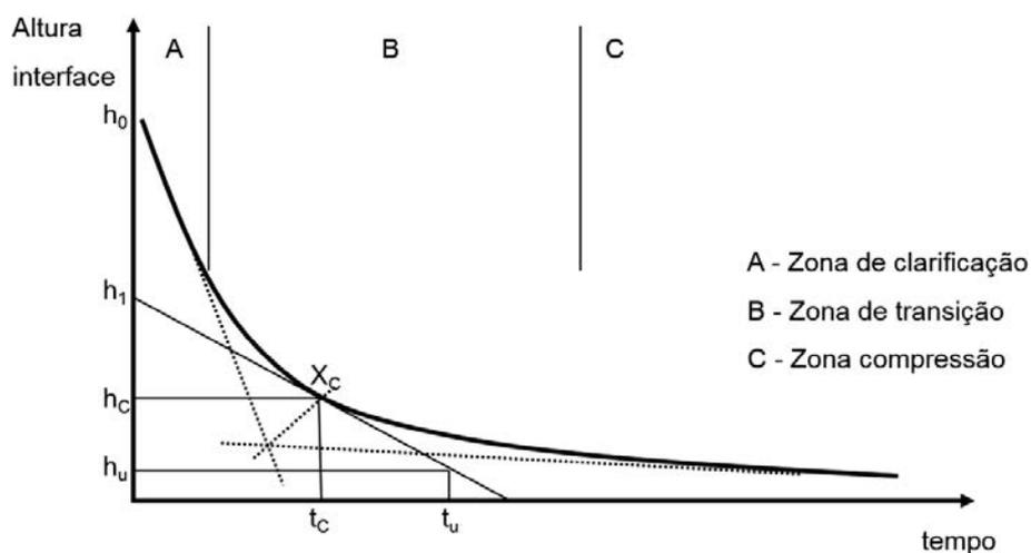
A análise realizada para a sedimentação em descontínuo também pode ser aplicada a decantadores secundários contínuos com alguns limites, nomeadamente o facto da coluna não ter raspadores de fundo nem velocidade de escoamento.
