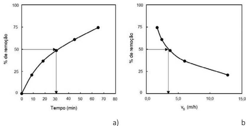
5.º passo – dimensionamento do decantador – determinação do volume e da área superficial
