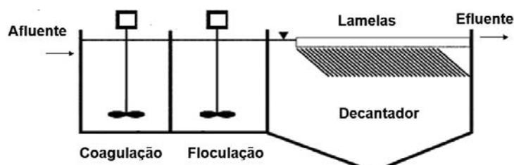
Os agitadores mecânicos de flocculadores mecanizados podem ser constituídos por hélices, turbinas ou roda de pás fixas a um eixo que gira na horizontal ou na vertical, conforme ilustrado na Figura 17.2.
