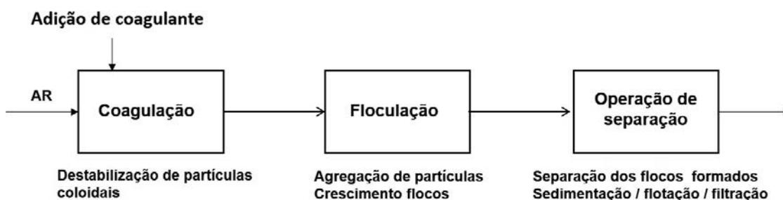
Quando a partícula coloidal desenvolve carga elétrica à sua superfície (geralmente negativa) passa a constituir um núcleo rodeado de uma dupla camada de iões, pois a partícula coloidal atrai iões de carga contrária, os quais aderem à sua superfície por forças de atração eletrostática e de *van der Waals*, formando a chamada camada fixa ou de Stern, em torno da qual se forma uma camada de iões mais difusa, conforme representado na Figura 16.3 a).
