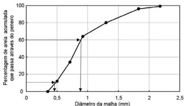
Do gráfico da Figura 14.7.1 determina-se o valor dos diâmetros do peneiro que deixam passar 10 e 60 % da massa de areia, respetivamente  $d_{10}$  e  $d_{60}$ :
