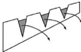
Quando a velocidade de saída do efluente se torna demasiado elevada para garantir condições de escoamento laminar há que aumentar a extensão dos descarregadores, o que se consegue introduzindo caleiras de recolha radiais ou em paralelo à caleira periférica, conforme ilustrado na Figura 11.12.
