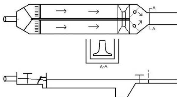
Os desarenadores de escoamento horizontal são aconselháveis para instalações de tratamento de pequena e média dimensão, não sendo aplicáveis em ETAR de grande dimensão, onde seriam necessários canais de elevado comprimento, com o inconveniente adicional de uma operação difícil e morosa, em virtude da grande quantidade de areias acumuladas na soleira de um longo canal. Nestes casos, a melhor opção passa por desarenadores arejados, tangenciais ou hidrociclones.
