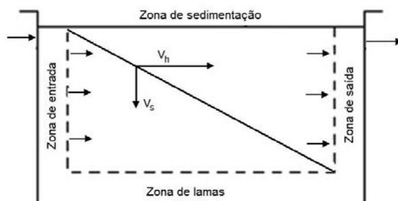
A velocidade de sedimentação é determinada pela expressão 9.5, que em determinadas condições (ver secção 9.2.2) pode assumir a forma da equação de Stokes.
