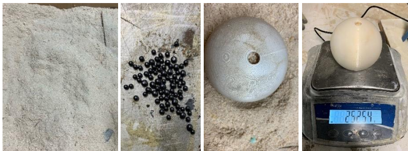
Fig. 117. Processo de enchimento do modelo de fruto.
