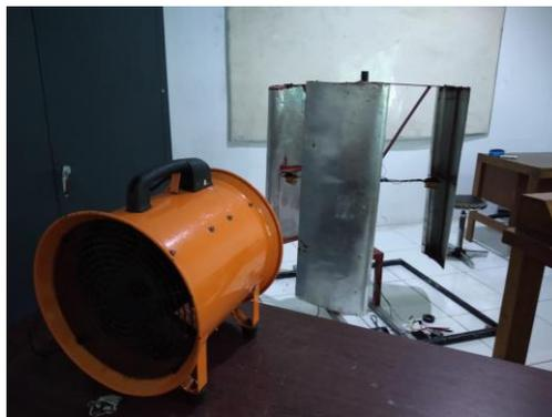
Gambar 3. Testbed pengujian sudut *pitch* VAWT terhadap kecepatan angin
