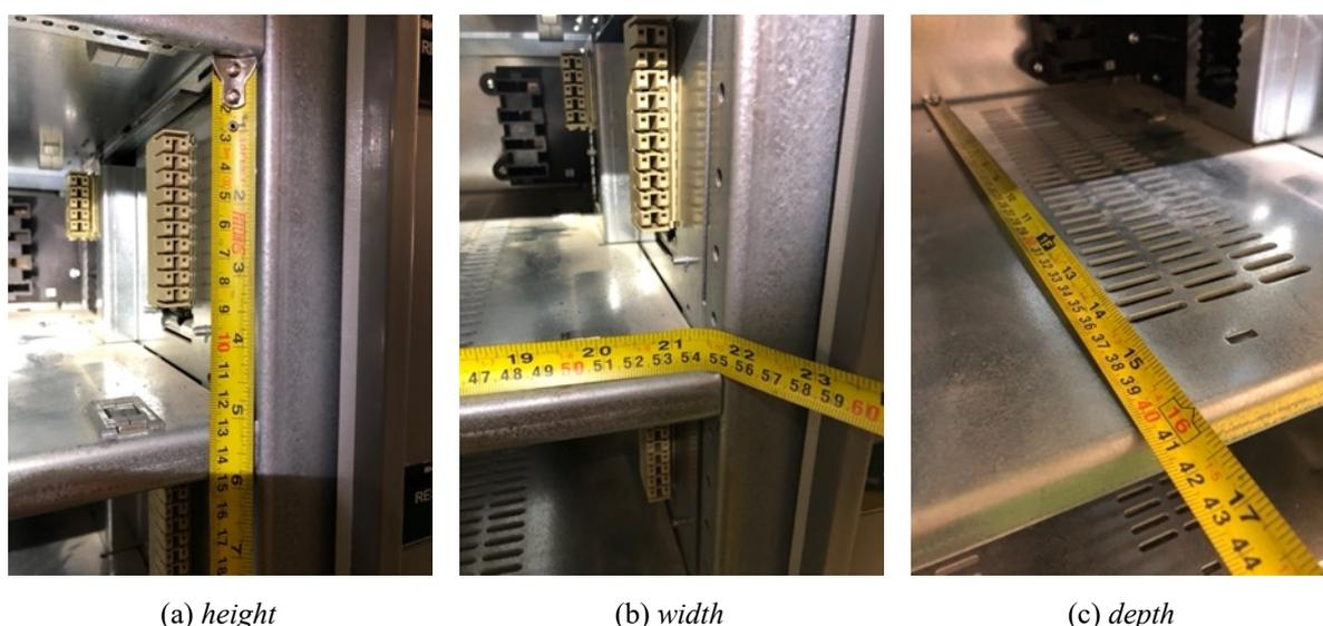
Figura 7.6 – PN-02: Determinação das dimensões do invólucro.
