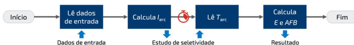
Figura 7.10 – Fluxograma de execução do script para o Estudo de Caso 1.
