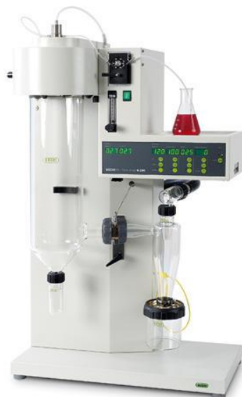
Slika 4. Sprej sušač Büchi mini B-290
