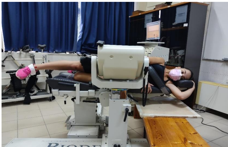
Εικόνα 3.2, Τοποθέτηση δοκιμαζόμενης στο ισοκινητικό δυναμόμετρο .
