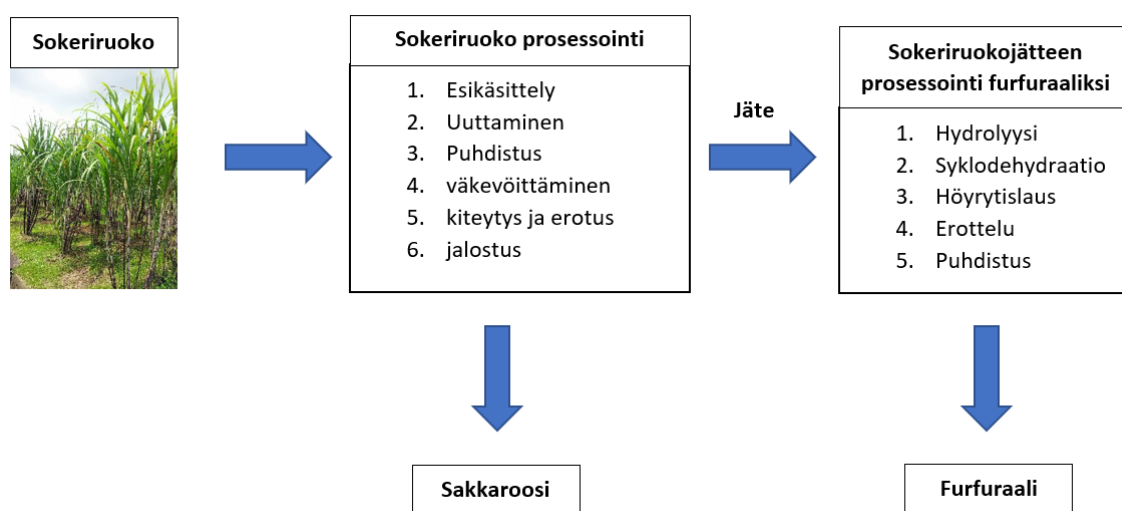
Kuva 2. Furfuraalin tuottaminen osana sakkaroosituotantoa sokeriruokosta. 23
