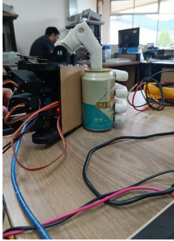
Figura 36. Sujeción de un embace de lata.
