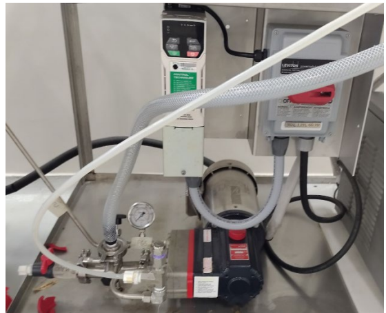
Figura 14. Motor acoplado a bomba de desplazamiento positivo en banco de pruebas
