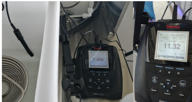
Figura 15. Sensor de temperatura y conductividad en el tanque de alimentación
