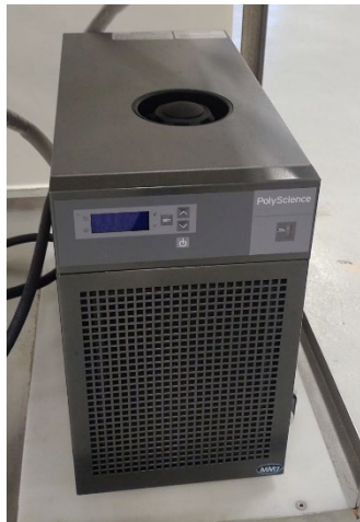
Figura 13. Chiller en banco de pruebas
