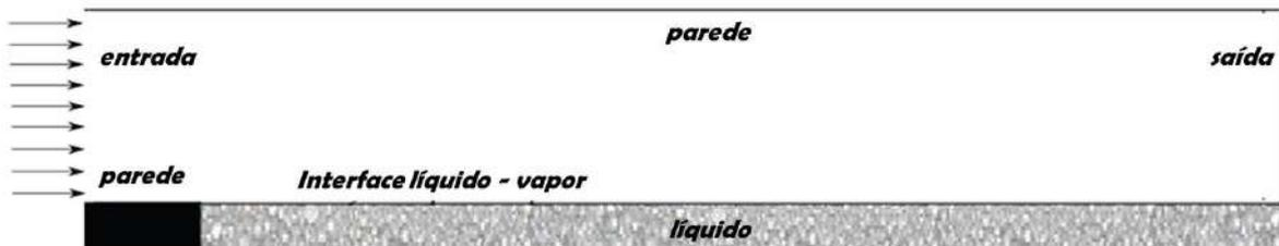
Figura 5.16: Geometria e condições de contorno.
