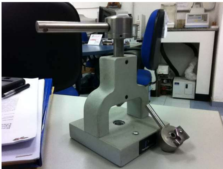
Figura 8 – Equipamento utilizado para lacrar as cápsulas de alumínio.
