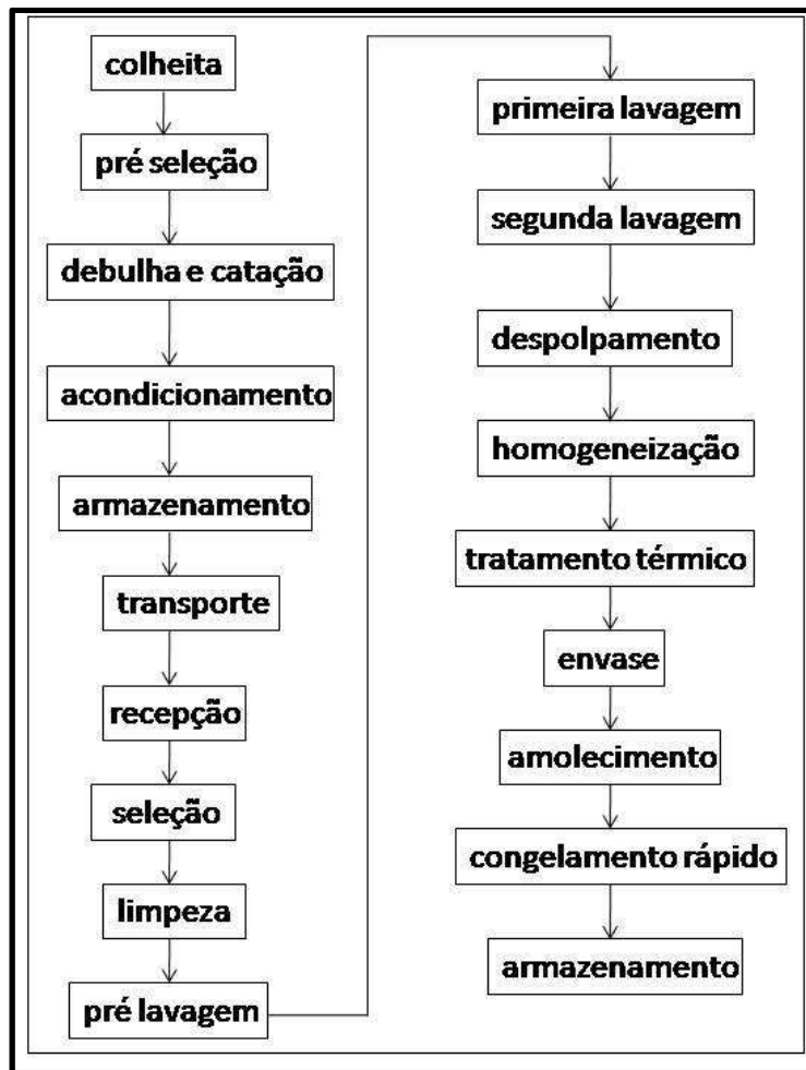
Figura 18: Diagrama de blocos do processamento dos frutos de açaizeiro.
