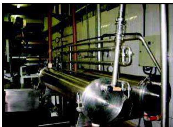
Figura 14: Pasteurizador tipo tubular para tratamento microbiológico de açai.
