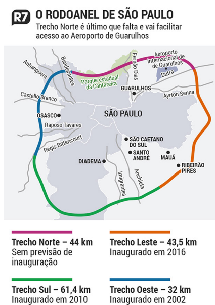
FIGURA 8 – À esquerda, diagrama dos trechos do Rodoanel. À direita, Rodoanel Norte em obras e indicação da futura conexão com o Aeroporto. Fontes: Edição dos autores (2020), com base em Portal R7 (à esquerda) e Google Earth (à direita).
