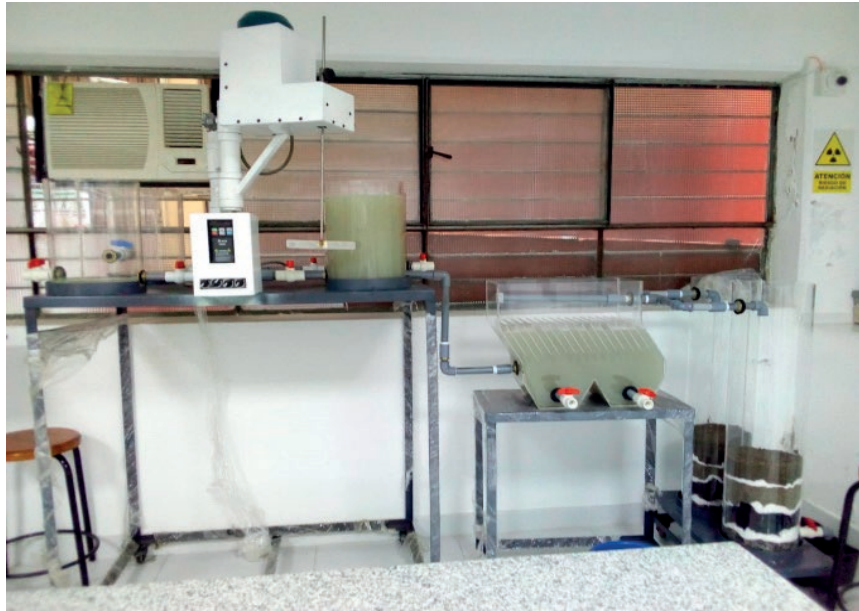
Figura 3 | Sistema piloto de tratamiento de aguas grises.
