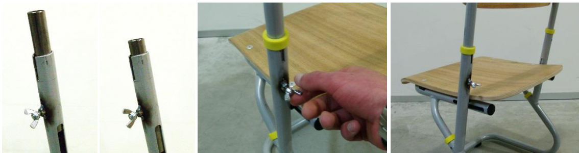
Figura 6.100 – Testes de bloqueio da posição da cadeira através do uso do parafuso de orelhas e da solução desenvolvida para bloquear a saída do parafuso de orelhas.
