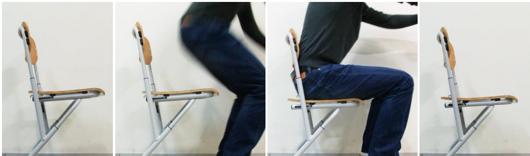
Figura 6.117 – Com a posição da cadeira bloqueada e ao realizar o movimento de sentar deixamos cair bruscamente o corpo sobre o assento, as estruturas movimentam-se ligeiramente entre si.
