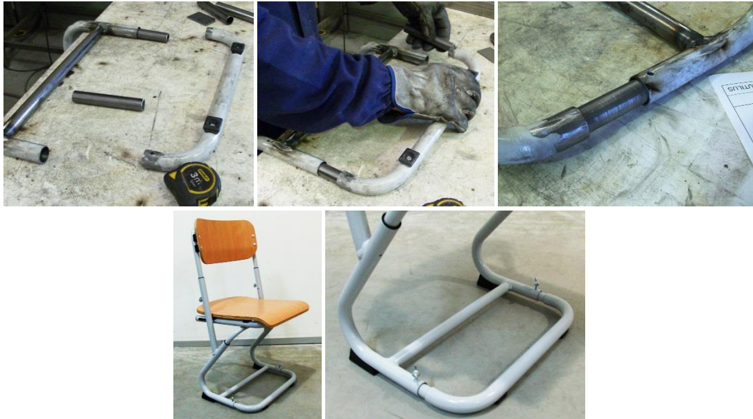
Figura 6.129 – Modificações realizadas ao protótipo 2 para testar a solução da base recuada.
