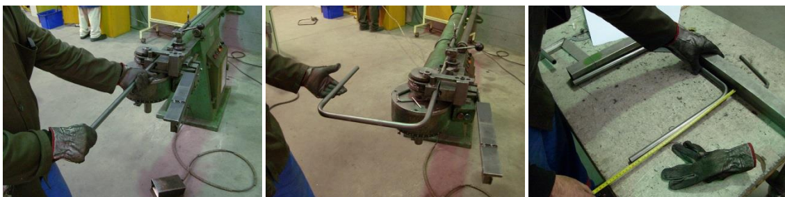
Figura 6.48 – Introdução do tubo no mandril, processo de dobragem e verificação das medidas da peça dobrada.
