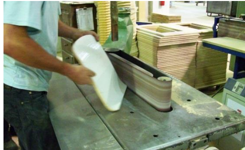
Figura 6.44 – Acabamento do assento: processo de lixagem.
