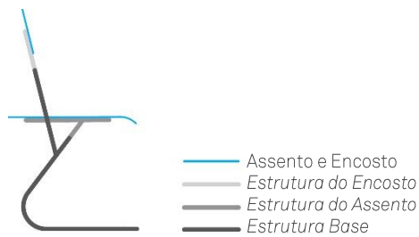
Figura 5.4 – As 3 estruturas que compõem a cadeira Dual_Step.
