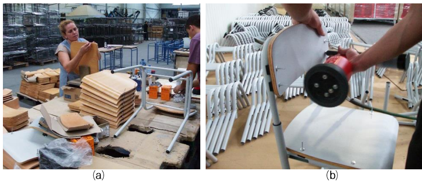
Figura 7.33 – Com as estruturas montadas, na segunda equipa o primeiro operador procede à incorporação dos rebites de repuxo de alumínio e dos elementos de amortecimento no encosto e assento (a) e o segundo operador à rebitação destes (b).
