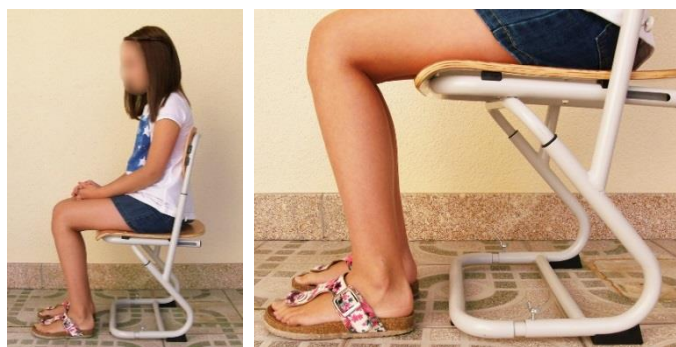
Figura 6.130 – Teste à solução da base recuada em 50mm em relação à aresta frontal do assento.
