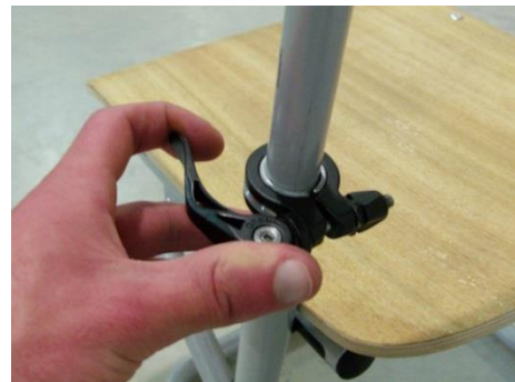
Figura 6.93 – Teste de bloqueio da posição da cadeira através de um aperto rápido.
