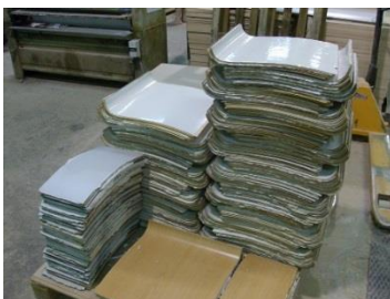
Figura 6.41 – Forma em bruto do assento e encosto após a prensagem.
