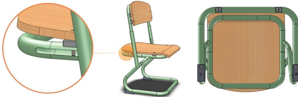
Figura 6.28 – Com um assento com a profundidade máxima possível de se obter através dos moldes existentes na empresa e com a solução de um suporte assento de duplo U o rasgo onde corre o mecanismo de regulção continuaria a ficar sobre uma zona de curva.
