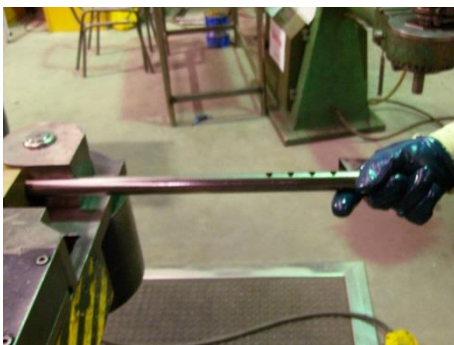
Figura 7.3 – Operador colocando o tubo da base no mandril, tendo em atenção o correto alinhamento das furações para se realizar a dobragem do mesmo.
