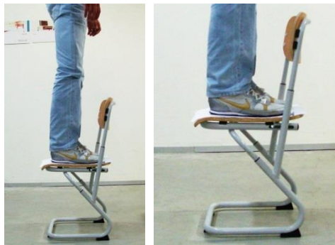
Figura 6.115 – Protótipo 2 submetido a testes de carga com um indivíduo de 70 Kg em cima do assento.
