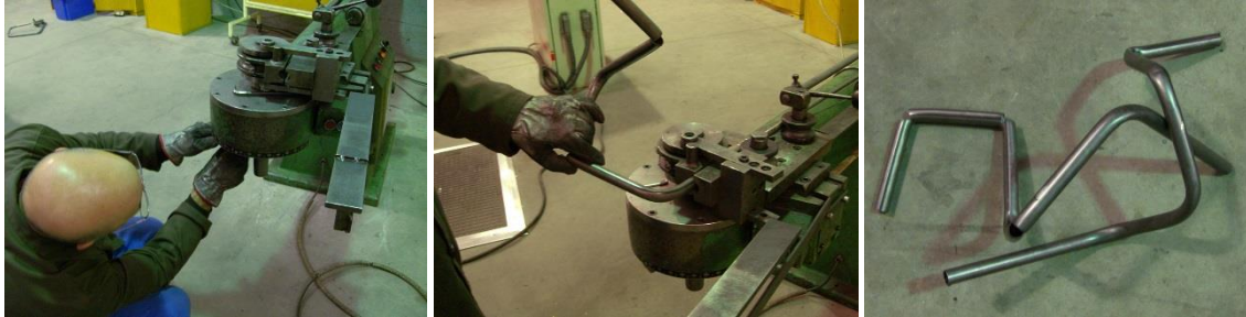
Figura 6.46 – Afiinação do ângulo de dobragem e testes de dobragem.
