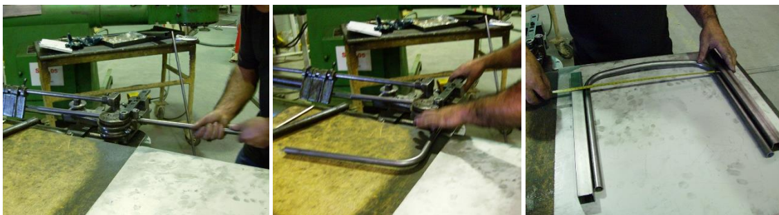
Figura 7.16 – Processo de dobragem da estrutura do encosto na máquina manual e verificação das medidas da peça dobrada.
