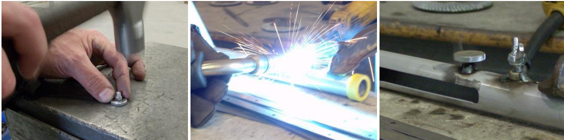
Figura 6.103 – Aplicação do parafuso serrilhado como alternativa ao parafuso de orelhas.
