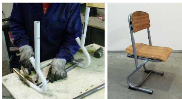
Figura 6.128 – Modificações ao protótipo 1 para testar solução da base cortada e unida com travessa recuada.
