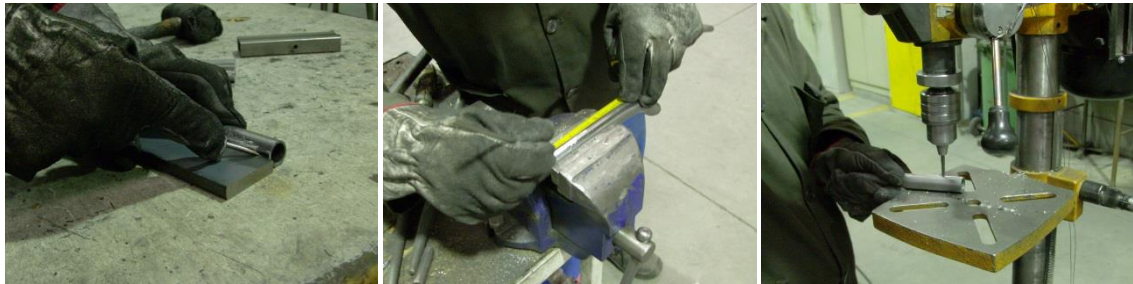
Figura 6.53 – Processo de furação do encaixe assento .
