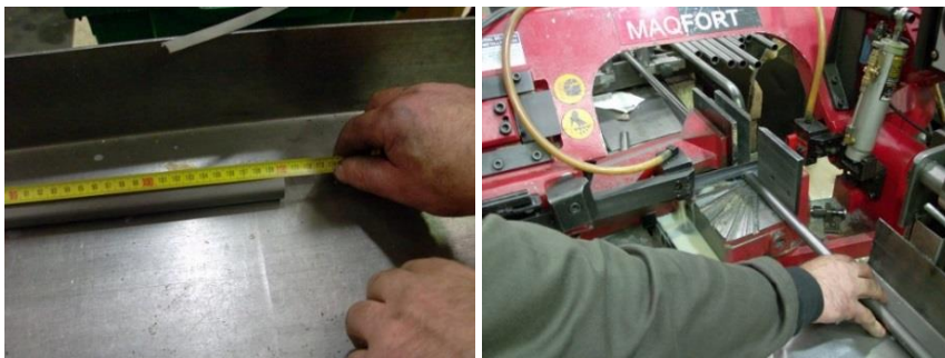
Figura 6.47 – Corte do tubo à medida no serrote elétrico de fita circular.
