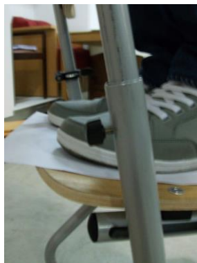
Figura 6.96 – Protótipo 1 submetido a uma carga de 70 Kg usando os manípulos como mecanismo de bloqueio da posição da cadeira, em alternativa ao pino-mola.
