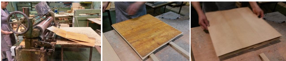
Figura 6.38 – Processo de impregnação das folhas de fuma (esquerda), a sua sobreposição sobre a folha de madeira de faia cosida (centro) e a colocação da segunda folha de madeira de faia cosida sobre as folhas de fuma (direita).
