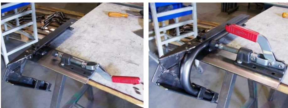
Figura 7.8 – Gabarit de furação da base .
