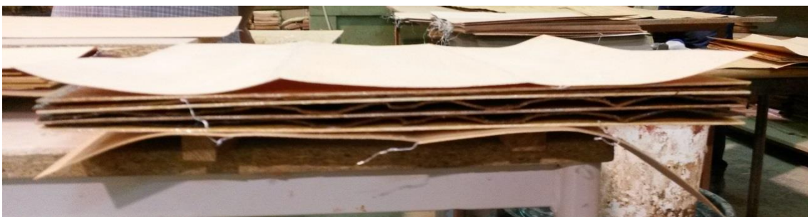
Figura 6.39 – Aglomerado de folhas de fuma e de madeira de faia resultante da sua sobreposição.
