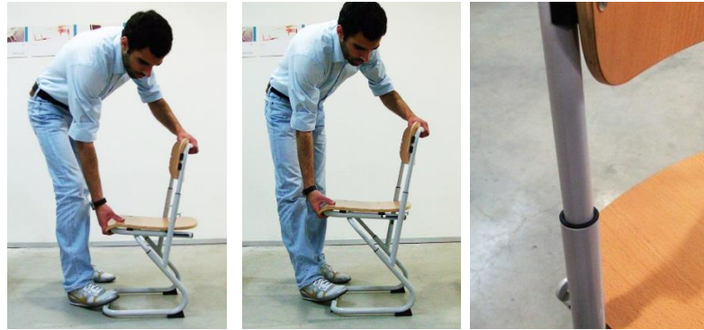
Figura 6.120 – Testes efetuados ao movimento de regulação da cadeira permitiram concluir que com o uso do casquilho em poliacetal o atrito entre estruturas é mínimo e os riscos inexistentes.
