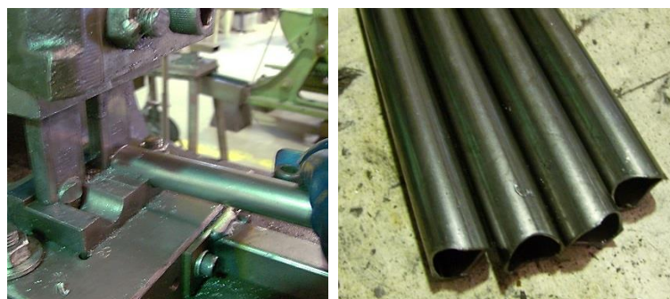
Figura 7.24 – Abertura de meia-cana da travessa no balancé.
