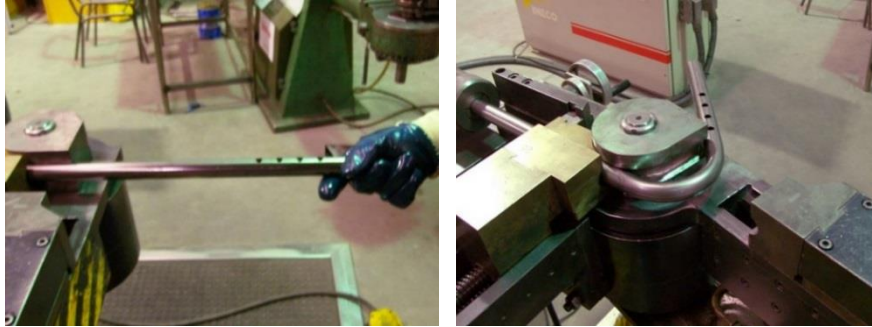
Figura 7.22 – Operador a introduzir o tubo da base no mandril tendo em conta o alinhamento da furação, e peça dobrada.
