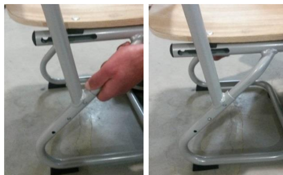
Figura 6.80 – Com os pinos-mola retirados do furo de bloqueio de onde foram empurrados, procede-se à regulação da cadeira até que os pinos-mola encontrem os furos de bloqueio seguintes.
