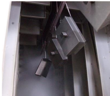
Figura 6.69 – Peças a saírem do túnel onde é realizado o tratamento da superfície.
