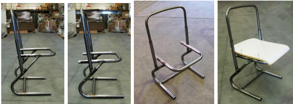
Figura 7.13 – Teste aos gabarits de soldadura com a montagem de uma cadeira para validação.
