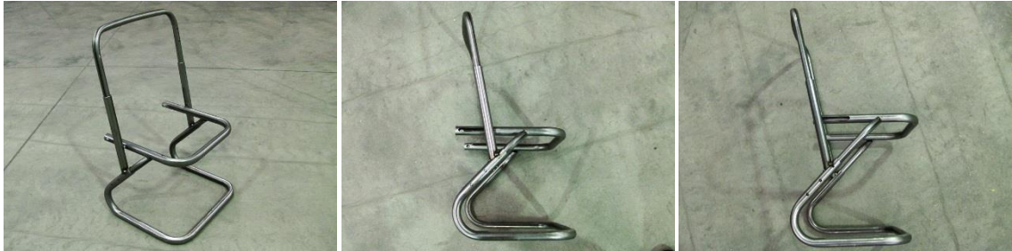
Figura 6.67 – Estrutura base, estrutura do assento e estrutura do encosto assembled após a soldadura.
