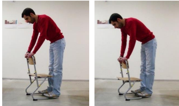
Figura 6.90 – Testes realizados ao movimento das estruturas na regulação da cadeira já com a incorporação dos casquilhos externos em PLA.
