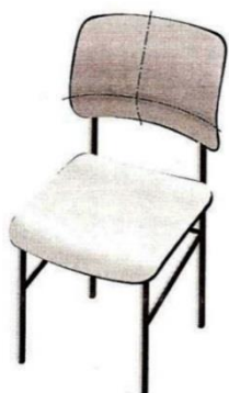
Figura 3.20 – Forma correta para o design do encosto separado do assento de uma cadeira. Fonte: Instituto Biomecânica de Valencia [48].
