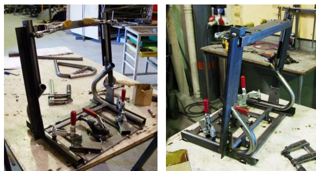
Figura 7.11 – Gabarit de soldadura da base + encaixe base com a travessa .
