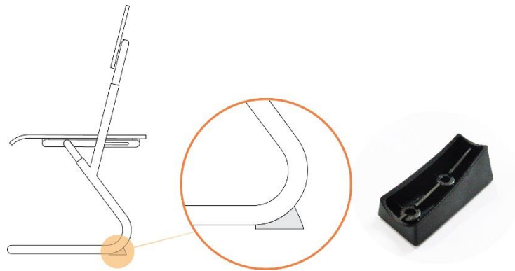
Figura 6.9 – Apoio ao solo em poliamida sugerido para evitar quedas para trás.
