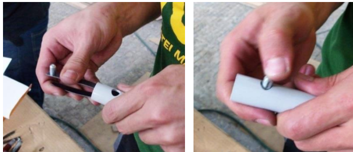
Figura 7.30 – Operador a inserir o sistema pino-mola no encaixe assento .
