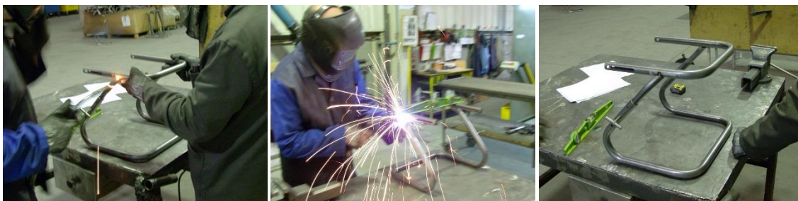
Figura 6.66 – Processo de soldadura dos subcomponentes da estrutura do assento .
