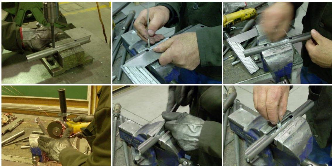
Figura 6.63 – Processo de abertura dos rasgos no encaixe base , no qual irão correr o espaçador de nylon que permitirão a regulação da cadeira.
