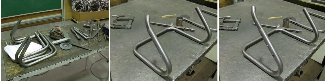
Figura 6.64 – Subcomponentes da cadeira Dual_Step sendo posicionados para o processo de soldadura a MIG.
