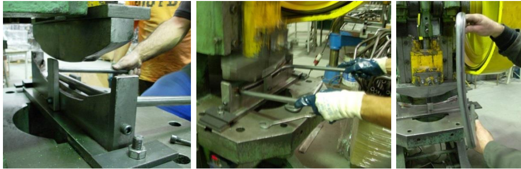
Figura 7.17 – Processo de prensagem da estrutura do encosto no balancé.
