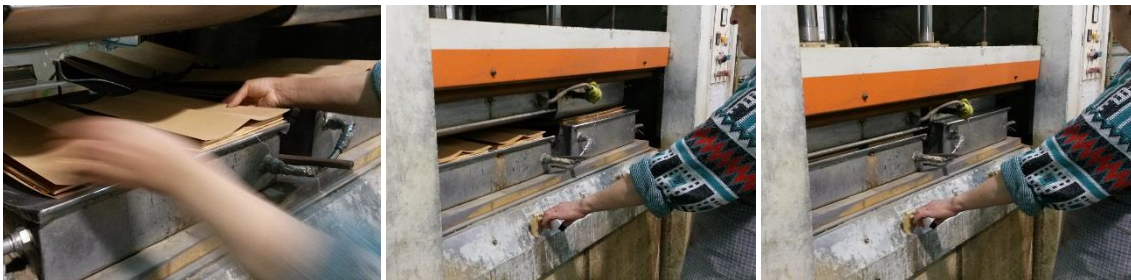
Figura 6.40 – Colocação do “aglomerado” de folhas de fuma e de madeira de faia no interior dos moldes e fecho da prensa hidráulica.
