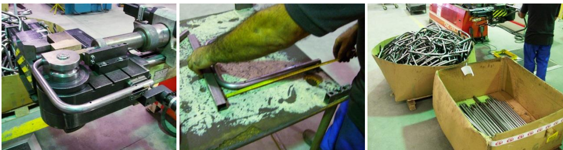
Figura 7.21 – Dobragem do suporte assento na máquina CNC e verificação das medidas da peça dobrada.
