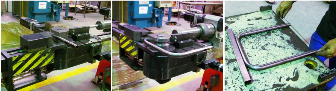
Figura 7.7 – Processo de dobragem do tubo do suporte assento e verificação das medidas da peça dobrada.
