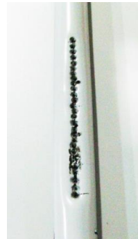
Figura 6.126 – Serrilhado na estrutura do encosto sob a forma de calotes esféricas.
