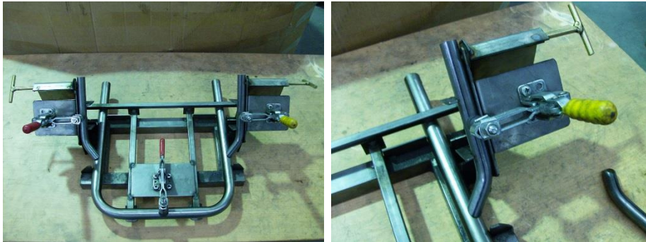
Figura 7.12 – Gabarit de soldadura do suporte assento com o encaixe assento.
