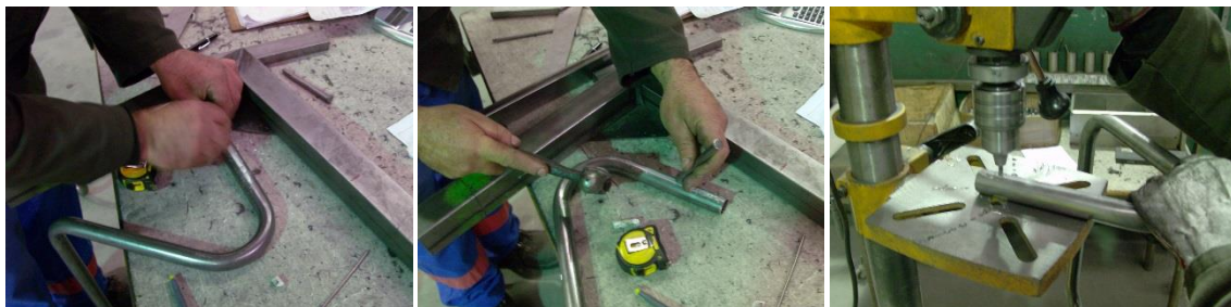
Figura 6.60 – Processo de furação da base.
