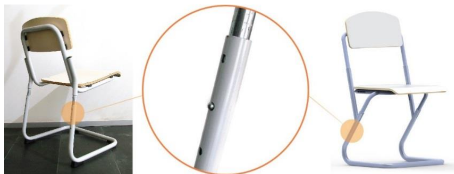
Figura 5.7 – Sistema pino-mola da cadeira UNI_STEP usado na cadeira Dual_Step.
