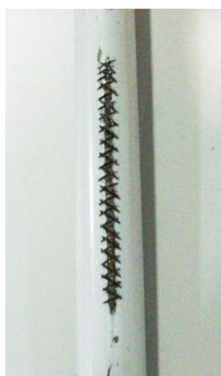
Figura 6.123 – Serrilhado na estrutura do encosto sob a forma de cruz.
