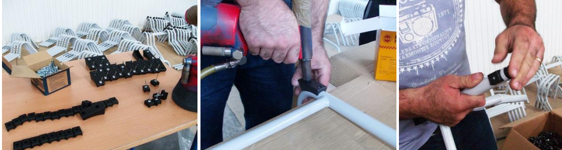
Figura 7.29 – Operador a rebitar os apoios ao solo e a inserir os tapa-topos na estrutura base .
