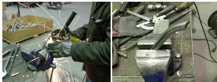
Figura 6.54 – Corte oblíquo numa das extremidades do encaixe assento .
