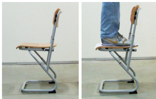
Figura 6.116 – O assento quando submetido a carga assume um alinhamento horizontal, tal como projetado.
