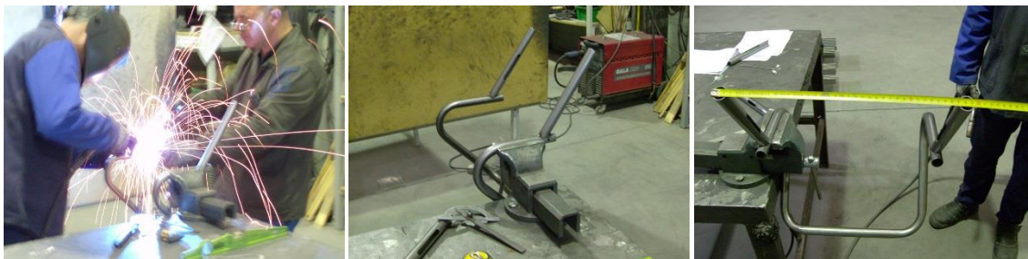
Figura 6.65 – Processo de soldadura dos subcomponentes da estrutura base .
