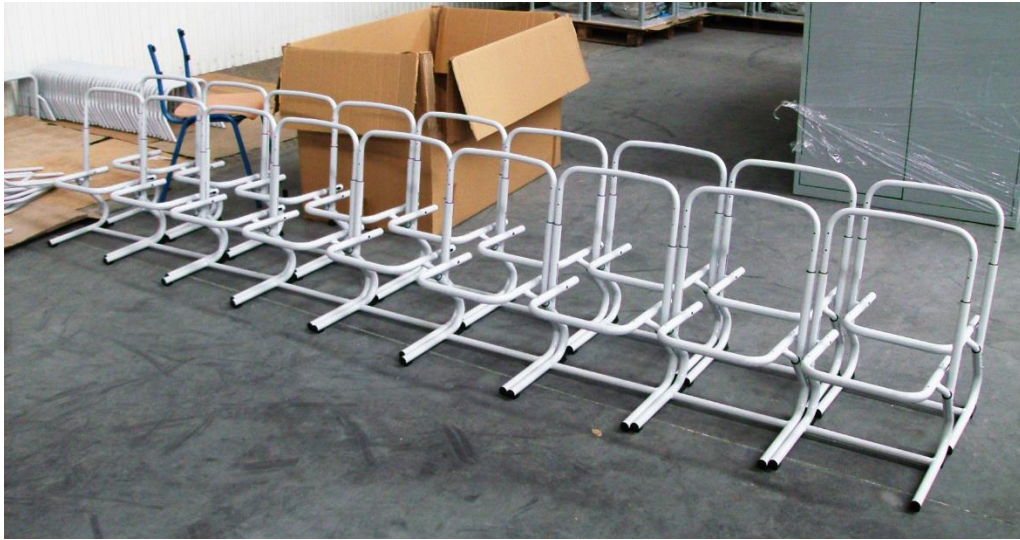
Figura 7.32 – Estruturas da cadeira montadas.
