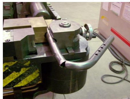
Figura 7.4 – Devido à furação existente na zona de curva o tubo rasgou no processo de dobragem.
