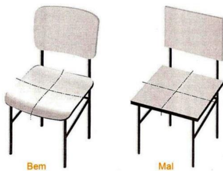
Figura 3.14 – Formas corretas e incorretas para o design do assento da cadeira escolar.
