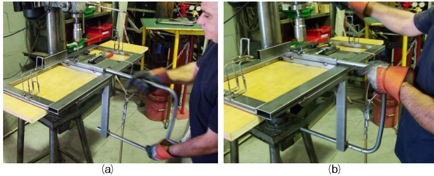
Figura 7.20 – Com a furação do encosto concluída o operador reposiciona a estrutura do encosto (a) para proceder à furação para o mecanismo de regulação no lado esquerdo (b)
