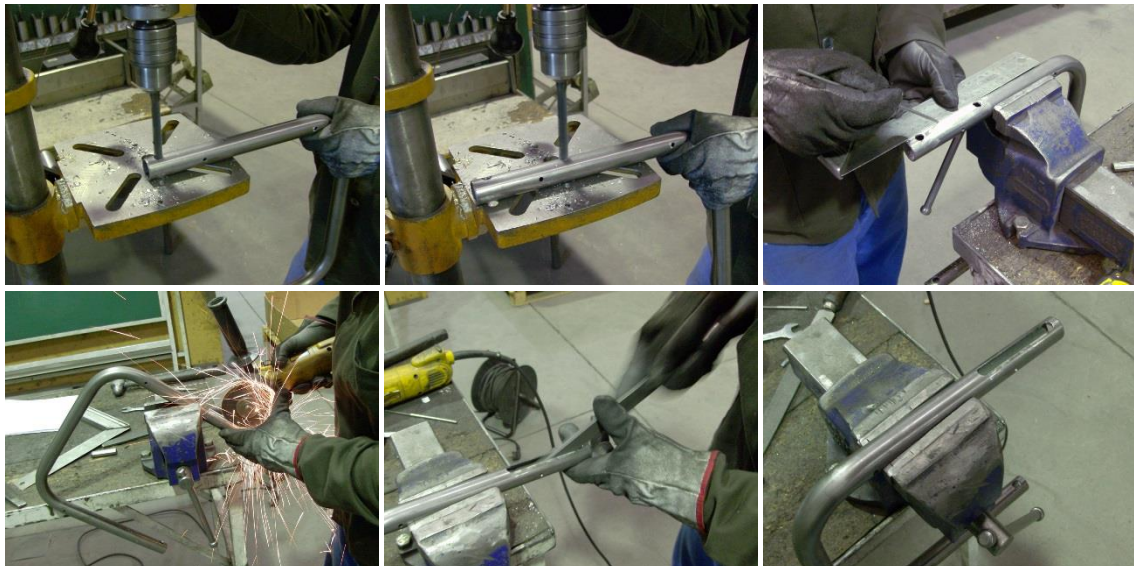
Figura 6.58 – Processo de abertura dos rasgos no suporte assento e no qual irão correr o espaçador de nylon que permitirão a regulação da cadeira.
