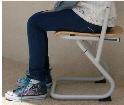
Figura 6.122 – Estando a estrutura base alinhada pela aresta frontal do assento, quando a criança tenta puxar a cadeira para a frente esta bate imediatamente nos calcanhares impedindo esse movimento.
