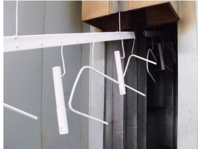
Figura 6.72 – Peças a saírem da estufa de polimerização após o processo de cura da tinta em pó.
