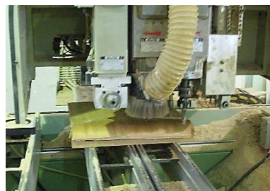
Figura 6.42 – Recorte e furação do assento.
