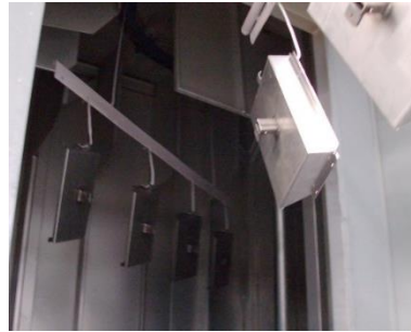
Figura 6.70 – Peças a entrar no túnel de secagem após o tratamento da superfície.
