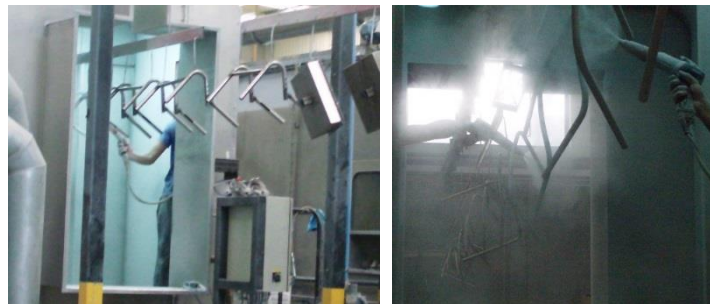
Figura 6.71 – Peças a entrar na cabine de pintura onde dois operadores munidos com pistolas de pulverização eletrostática pulverizam a tinta em pó sobre as peças, cobrindo a sua superfície.
