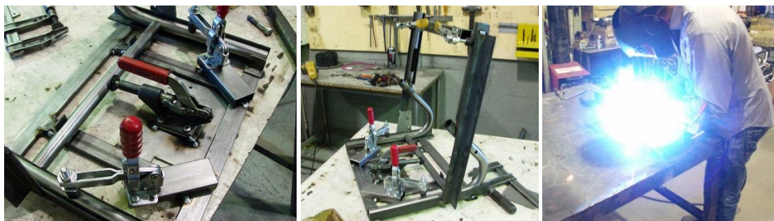
Figura 7.26 – Processo de soldadura da travessa e da base+encaixe base com recurso ao gabarit para esse efeito, obtendo-se assim o componente estrutura base .
