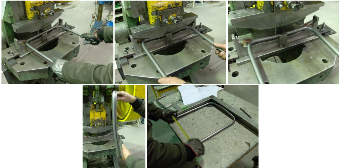
Figura 6.49 – Processo de prensagem da estrutura do encosto – introdução da peça no molde, fecho do molde e abertura do molde – e verificação das medidas após a prensagem.
