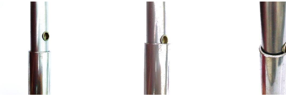
Figura 6.16 – Teste realizado à solução proposta na Figura 6.15 onde foi possível observar que a folga entre tubos não permite acomodar a cabeça da porca de rebite sem gola M6.
