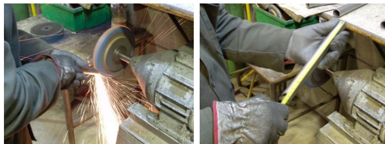
Figura 6.62 – Abertura de meia cana numa das extremidades do encaixe base e verificação das medidas.
