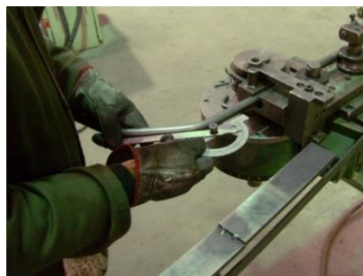
Figura 6.52 – Verificação do ângulo da peça dobrada.
