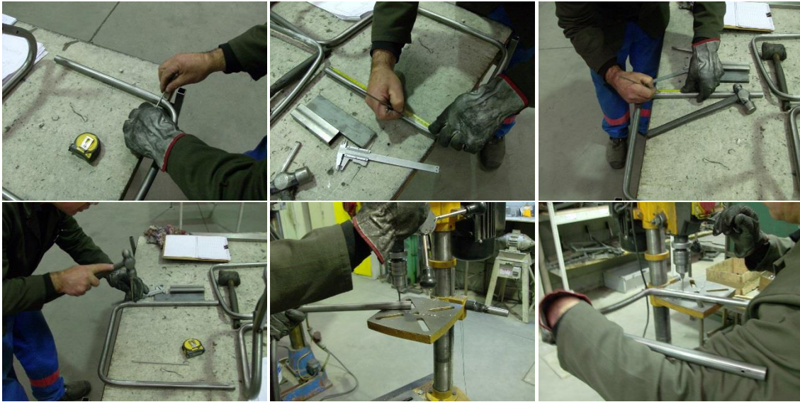
Figura 6.50 – Processo de furação da estrutura do encosto.
