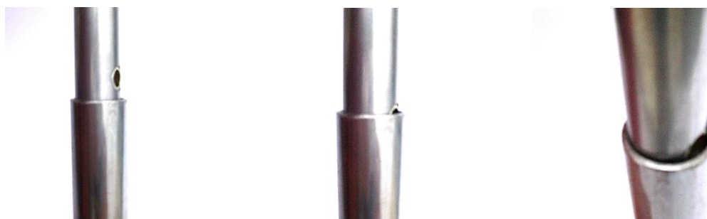
Figura 6.20 – Teste realizado à solução proposta na Figura 6.19 onde foi possível observar que se o furo que recebe a porca de rebite sem gola M6 fosse escareado tal permitia que a cabeça da porca de rebite coubesse na folga entre tubos.
