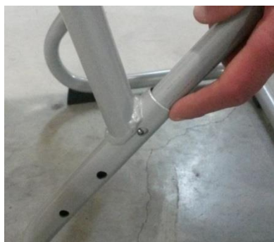
Figura 6.79 – Após empurrar o pino-mola é necessário ‘forçá-lo’ de modo a não coincidir com o furo de bloqueio de onde fora empurrado.
