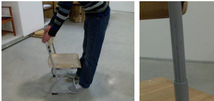
Figura 6.77 – Testes efetuados ao movimento de regulação da cadeira. Além do atrito existente, a pintura começou a ficar riscada na estrutura do encosto e estrutura do assento .
