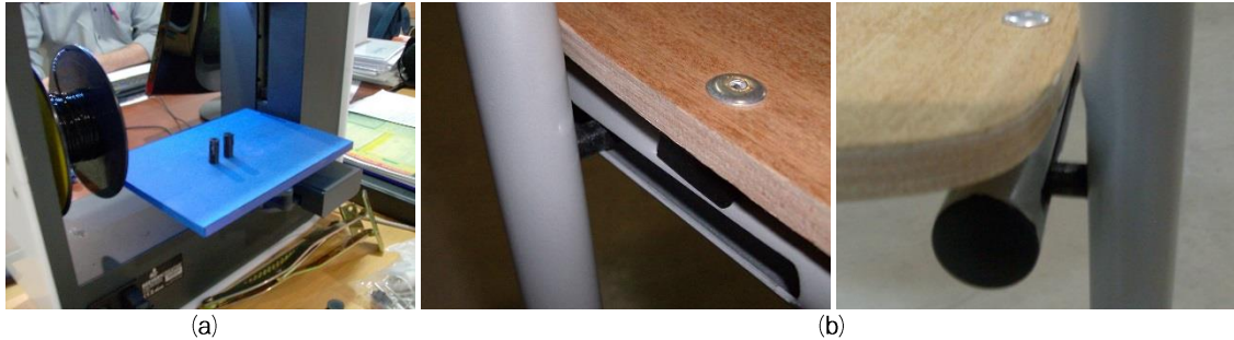
Figura 6.81 – Impressão 3D em PLA dos espaçadores sem rosca (a) e a sua incorporação no mecanismo de regulação para a realização de testes de melhoria do movimento de rotação do espaçador (b).
