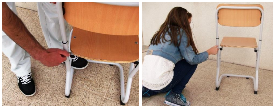
Figura 6.119 – A criança não é capaz de desapertar o parafuso serrilhado se este fosse apertado por um adulto com esse propósito.
