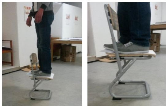
Figura 6.82 – Protótipo 1 submetido a testes de carga com um indivíduo de 70 Kg em cima do assento.
