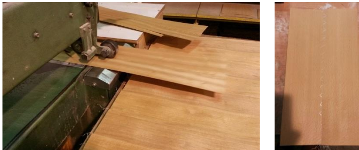
Figura 6.36 – Máquina a coser as folhas de madeira de faia (esquerda) e duas folhas de madeira de faia cosidas (direita).
