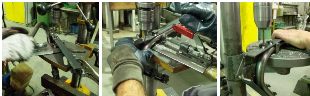
Figura 7.23 – Processo de furação da base com recurso ao gabarit para esse efeito.
