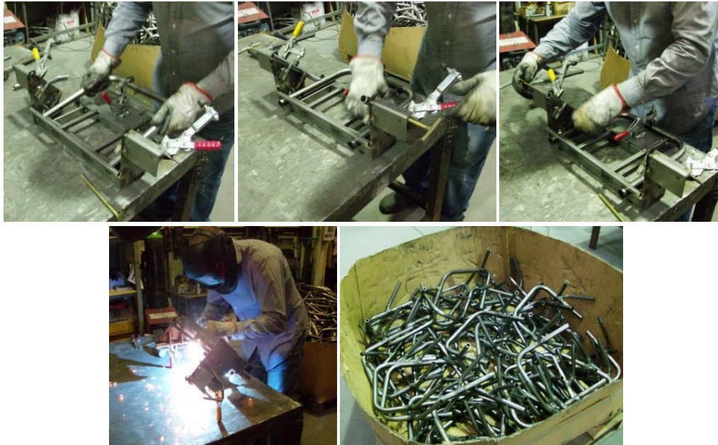
Figura 7.27 – Processo de soldadura do suporte assento e do encaixe assento com recurso ao gabarit para esse efeito, obtendo-se assim o componente estrutura assento .
