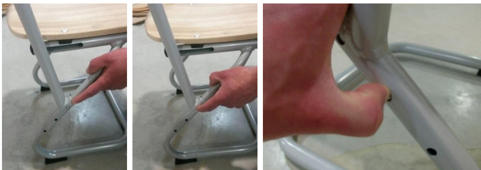
Figura 6.78 – Operação para empurrar o pino-mola de modo a libertá-lo do furo de bloqueio. Devido à espessura de 2mm do tubo da base , onde se encontram os furos de bloqueio, era necessário empurrar o pino com a ponta do dedo.
