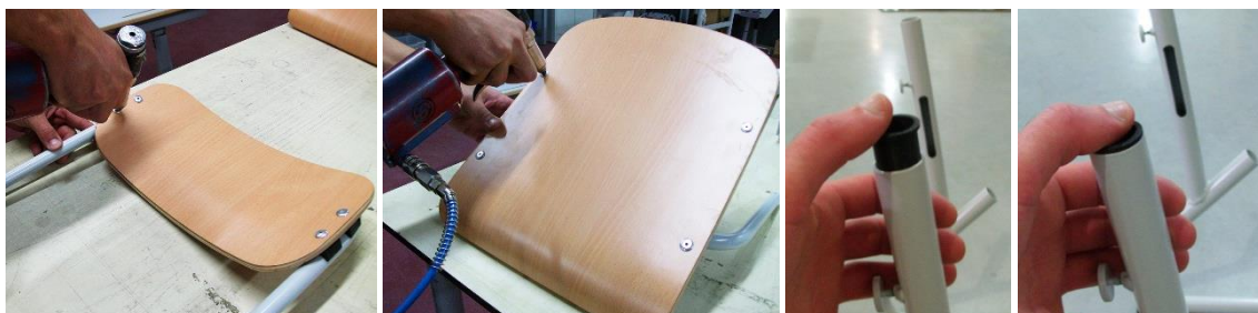
Figura 6.112 – Montagem do protótipo 2: rebitagem do encosto e do assento por meio de um rebitador pneumático e introdução dos casquilhos em poliacetal na estrutura base .
