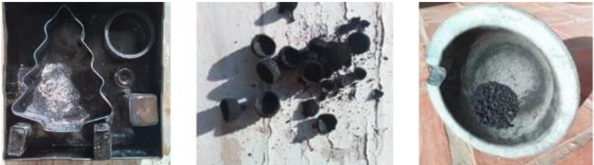
Figura 41 Processo de carbonização. Da esquerda para a direita: 1 - Recipientes usados para separar e organizar as matérias orgânicas carbonizadas. 2- Cascas de bolota de carrasco carbonizadas. 3- As mesmas cascas moídas no almofariz.
