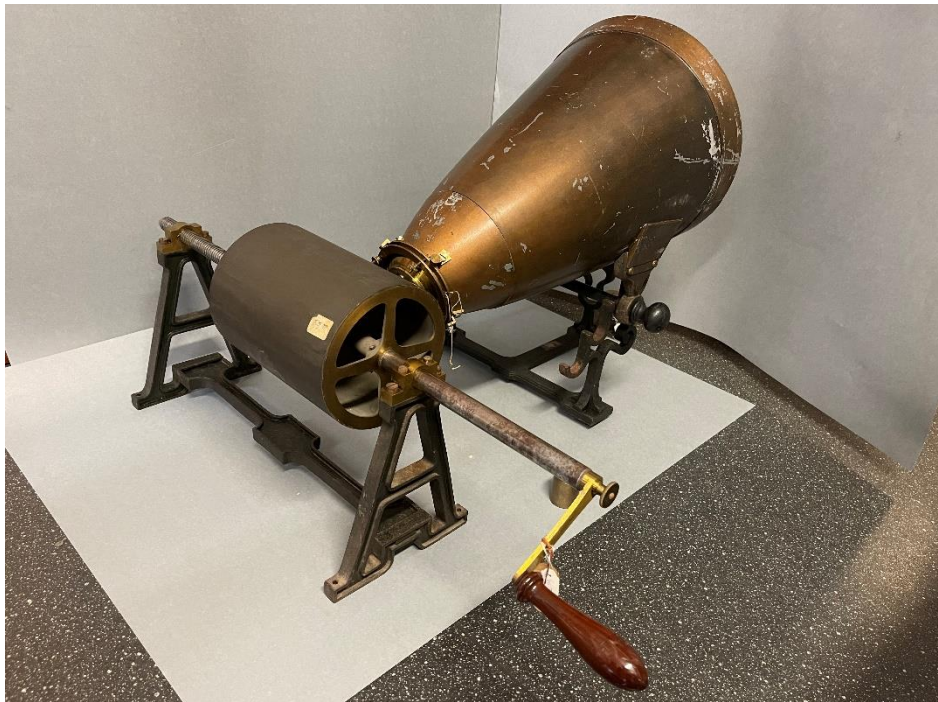
Figura 2 - Fonoautógrafo. Instituto Superior de Engenharia do Porto. Fotografia de João Marçal
