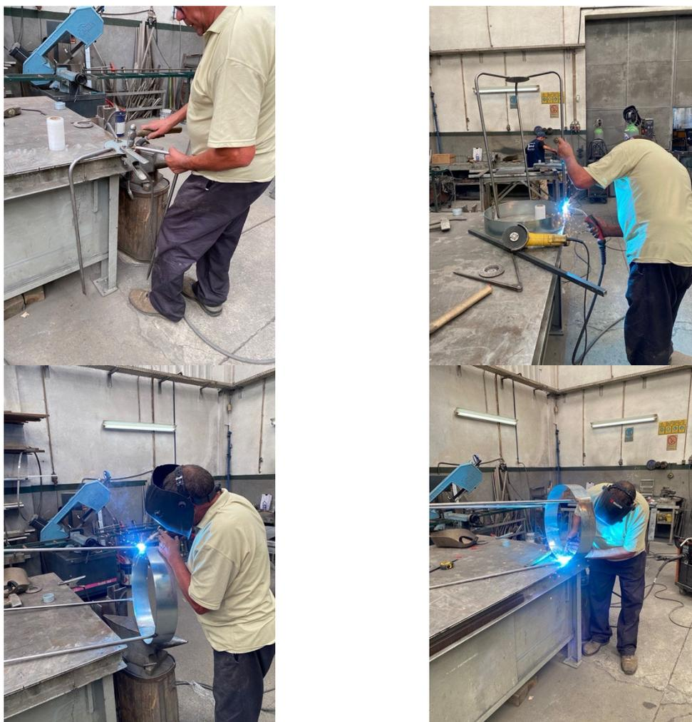
*Figura 57 - Soldadura entre as três varas e o aro*
