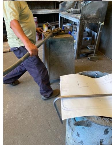
*Figura 48 - Escolha do material, corte e quinagem das varas*
