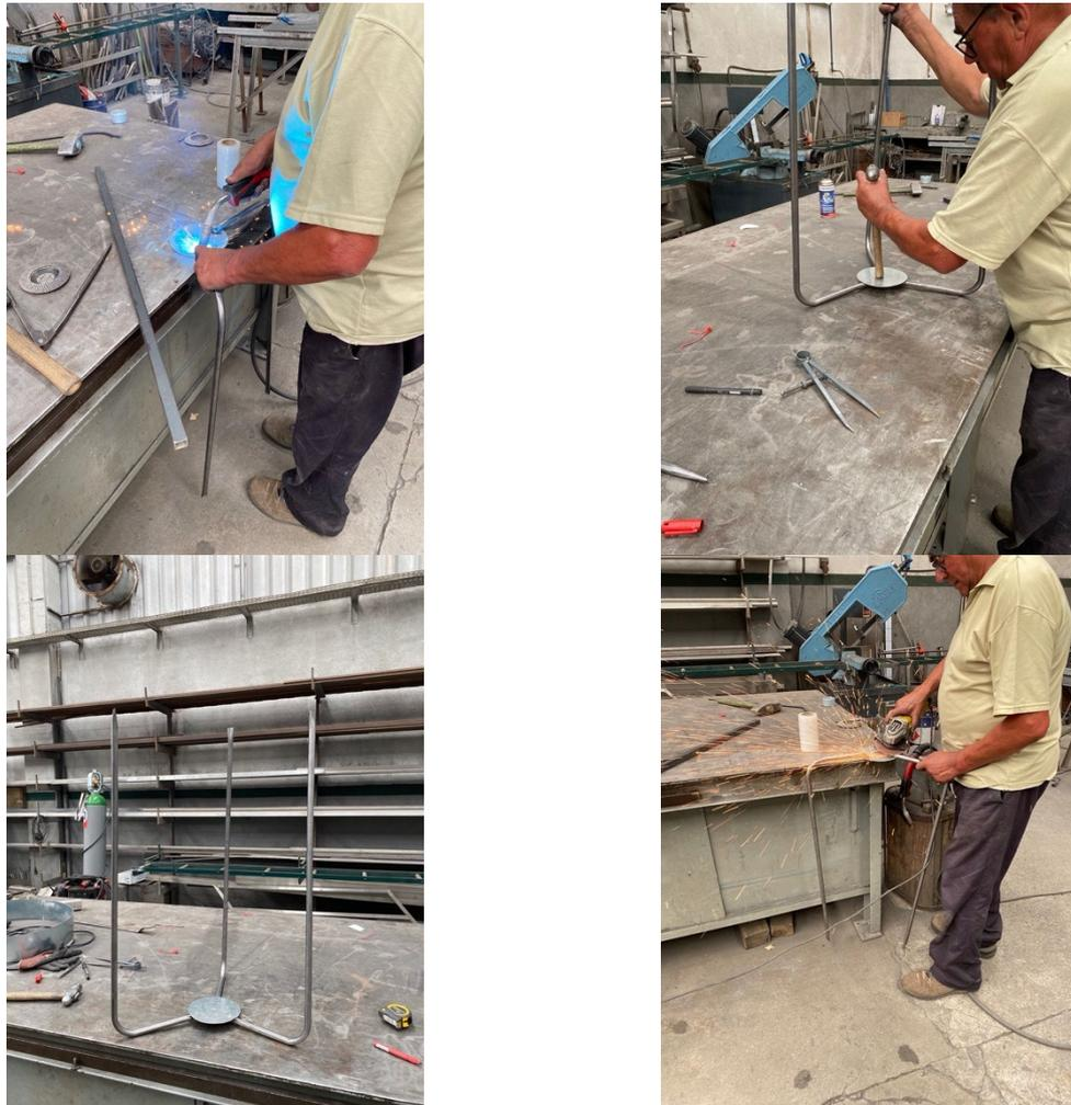
*Figura 56 - Soldadura entre as três varas com a chapa da base*
