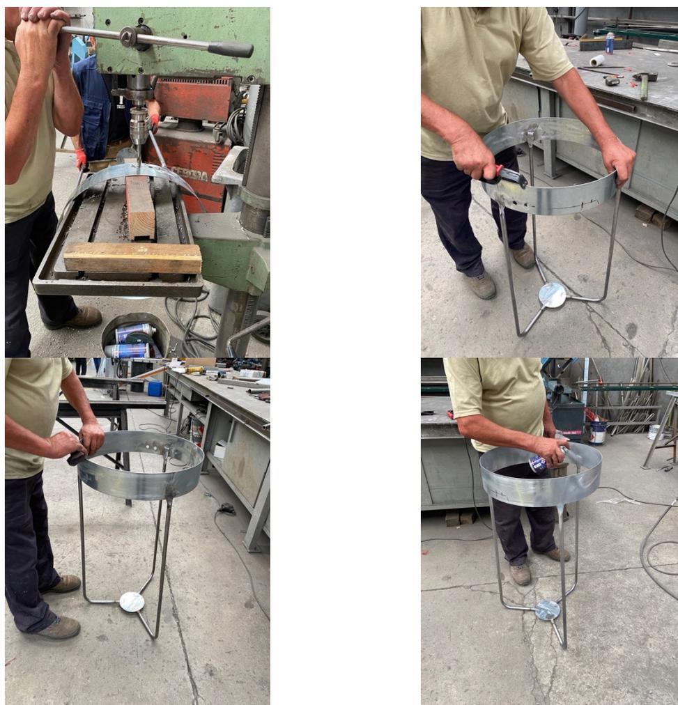
*Figura 59 - Perfuração do aro, limagem, recortes finais e uso do spray de zinco*
