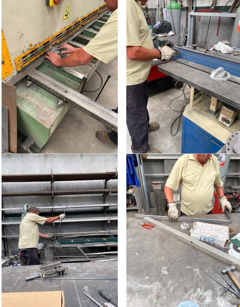
Figura 53 - Corte da chapa e aprimoramento das varas
