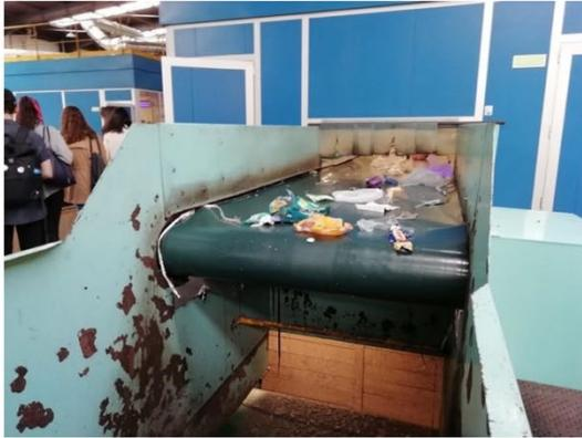
Imagem 18-Tapete rolante entre o Separador Balístico, Eletroímã e Sistema de Aspiração Automático
