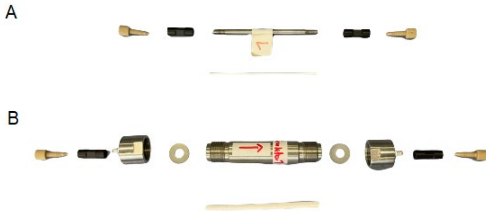
Abbildung 9: Vergleich der keramischen Kapillarmembran mitsamt Reaktormantel aus vorangegangenen Projektarbeiten (A) mit der in aktuellen Projektarbeiten verwendeten (B).
