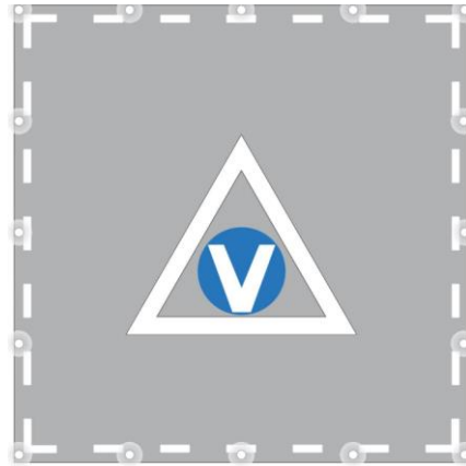
Fig.5.8 Sistema de iluminación FATO
