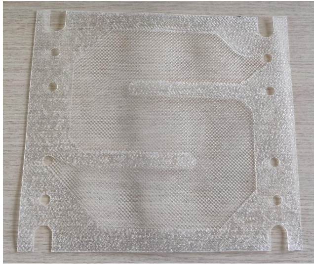
Figura 4. Spacers que se encuentran en el equipo de electrodiálisis de la universidad (Fuente: elaboración propia).
