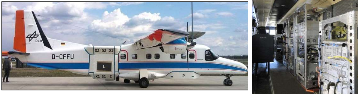
Abbildung 3-1: Do-228-212 Flugzeug mit angebauten F-SAR Antennen, und Blick ins Flugzeug-Innere mit F-SAR Racks
