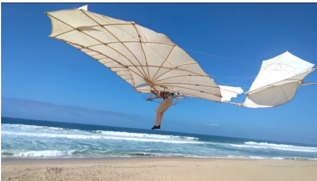
BILD 22. Getrimmte, freie Flüge mit einer maximalen Flugweite von 72 Metern. Die Flugdistanzen waren durch die Brandung begrenzt. - Markus Raffel, Marina Beach (CA) 2022
