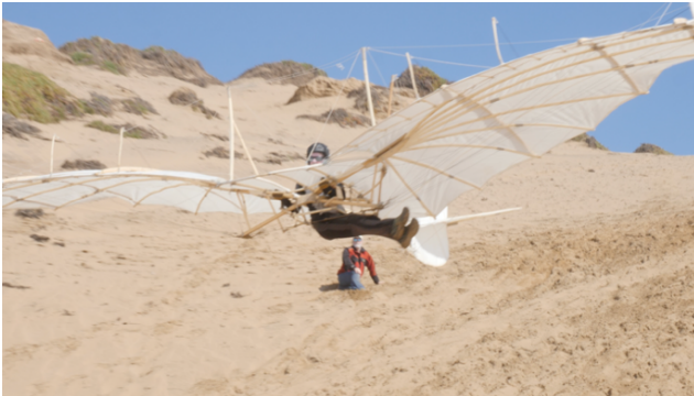
BILD 21. Übung der Giersteuerung mit dem über die Hüftgabel betätigten Seitenruder - Andrew Beem, 2022.
