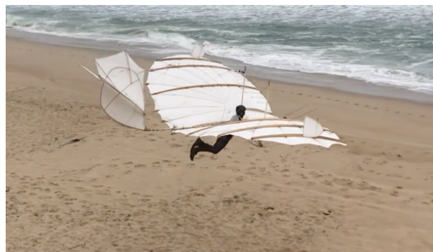
BILD 19. Eine ähnliche Fluglage, kurz vor der Landung. Andrew Beem richtet den Gleiter durch starke Gewichtsverlagerung nach hinten zum Abfangen auf.
