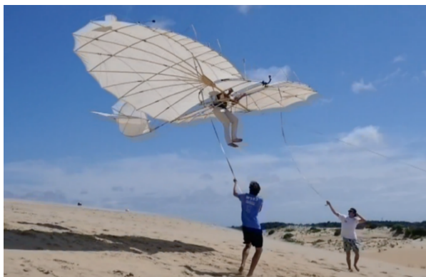
BILD 16. Üben der Quer- und Längssteuerung mit begrenztem Risiko - Fesselflugversuche auf den Outer Banks 2021.
