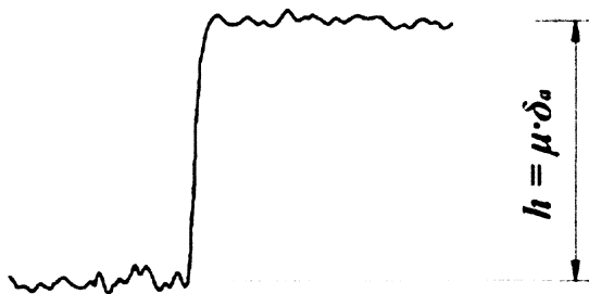
Рис. 3. Измерение толщины масляной пленки: h – значение сигнала на выходе измерительного канала; \mu – масштабный коэффициент; \delta a – относительное радиальное смещение колец подшипника
