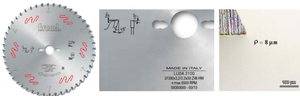
Figure 1 Saw blade PK48 (LU 2A 2100) and tooth blade edge Slika 1. List pile PK48 (LU 2A 2100) i radijus oštrice
