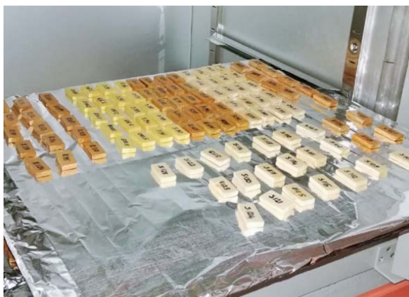
Figure 2 Test specimens (a) in air-conditioning chamber, (b) in petri dishes Slika 2. Ispitni uzorci: a) u klimatizacijskoj komori, b) u Petrijevim zdjelicama
