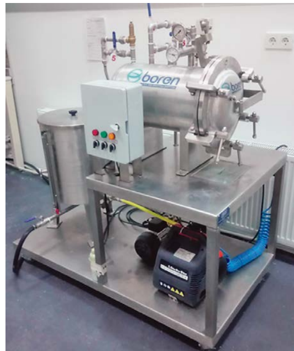
Figure 1 Vacuum-pressure wood impregnation system Slika 1. Vakuumsko-tlačni sustav za impregnaciju drva
