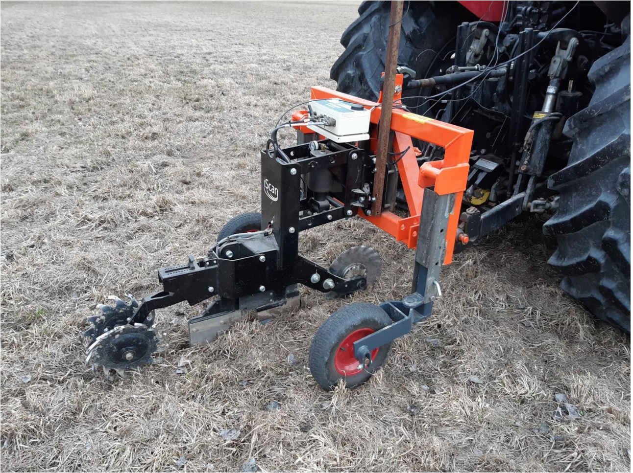
Kuva 7. Tutkimuksessa käytetty maaperäskanneri kiinnitettynä traktoriin. Oranssin kehikon avulla skannerin saa kiinnitettyä traktorin kolmipistenostolaitteeseen. Kuva: Antti Lajunen.
