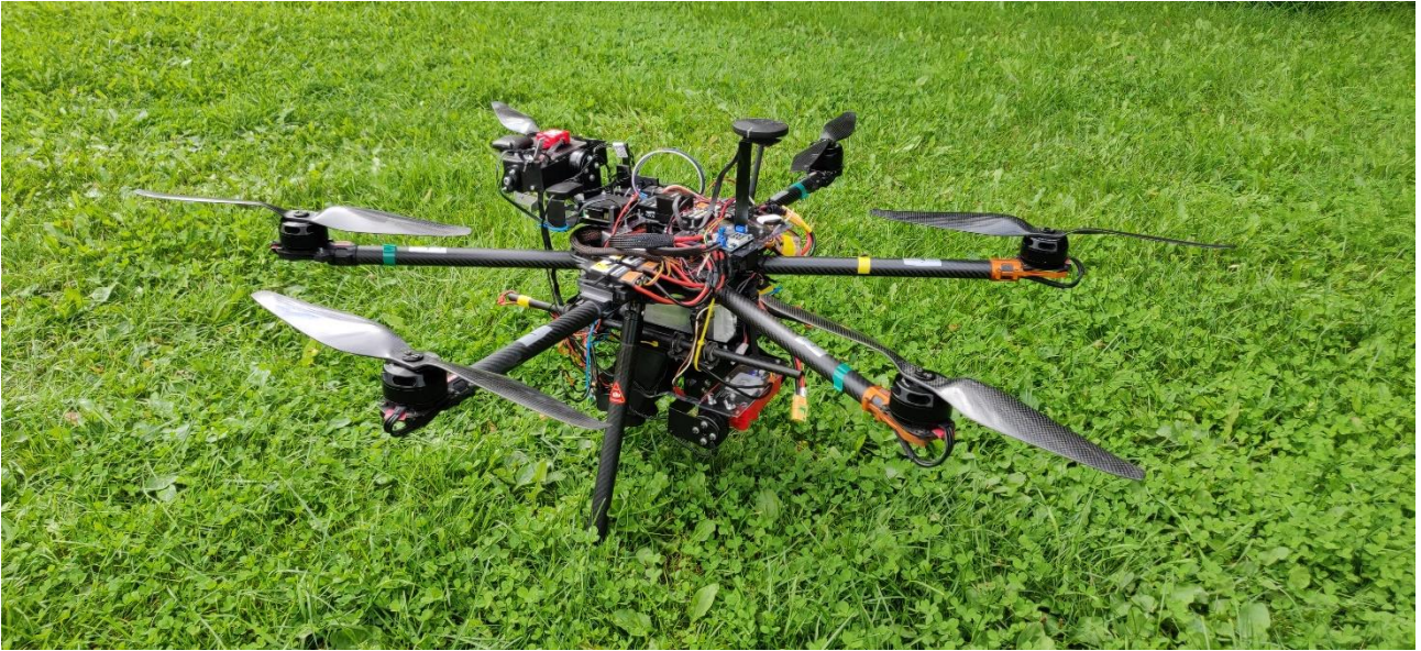
Kuva 2. Kuusiroottorinen drone varustettuna erilaisilla mittausvarusteilla. Kuva: Mikael Änäkkälä.
