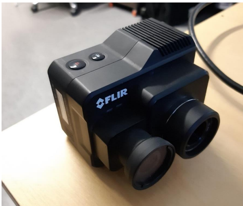
Kuva 4. Malliesimerkki dronessa käytettävästä lämpökamerasta. Kuva: Juha Jokiniemi.
