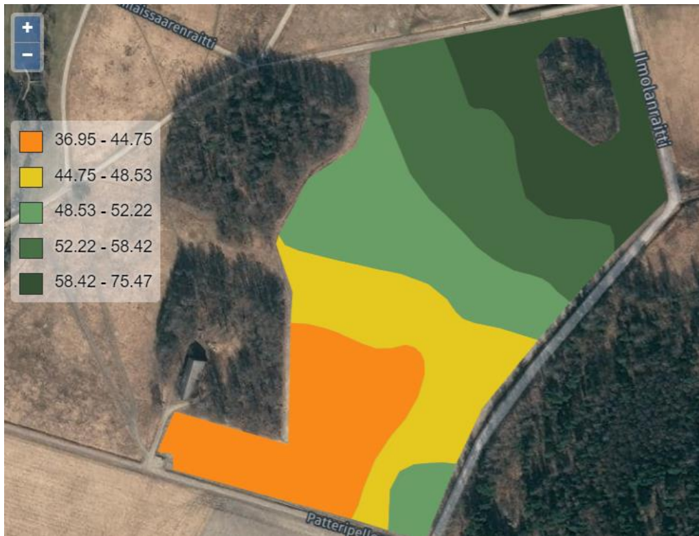
Kuva 22. Skannerin pilvipalvelun antama kosteuskartta 6.5. mitatusta alueesta (Mehiläissaari). Kuva: Antti Lajunen.
