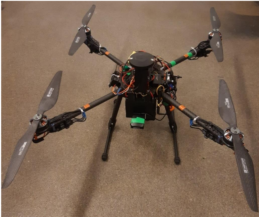
Kuva 6. Kuvauksissa käytetty drone varustettuna lämpökameralla. Kuva: Juha Jokiniemi.
