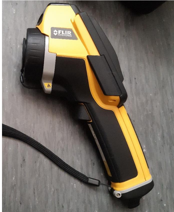
Kuva 3. Käsikäyttöinen lämpökamera, jossa myös kuvien tallennusmahdollisuus. Kuva: Juha Jokiniemi.
