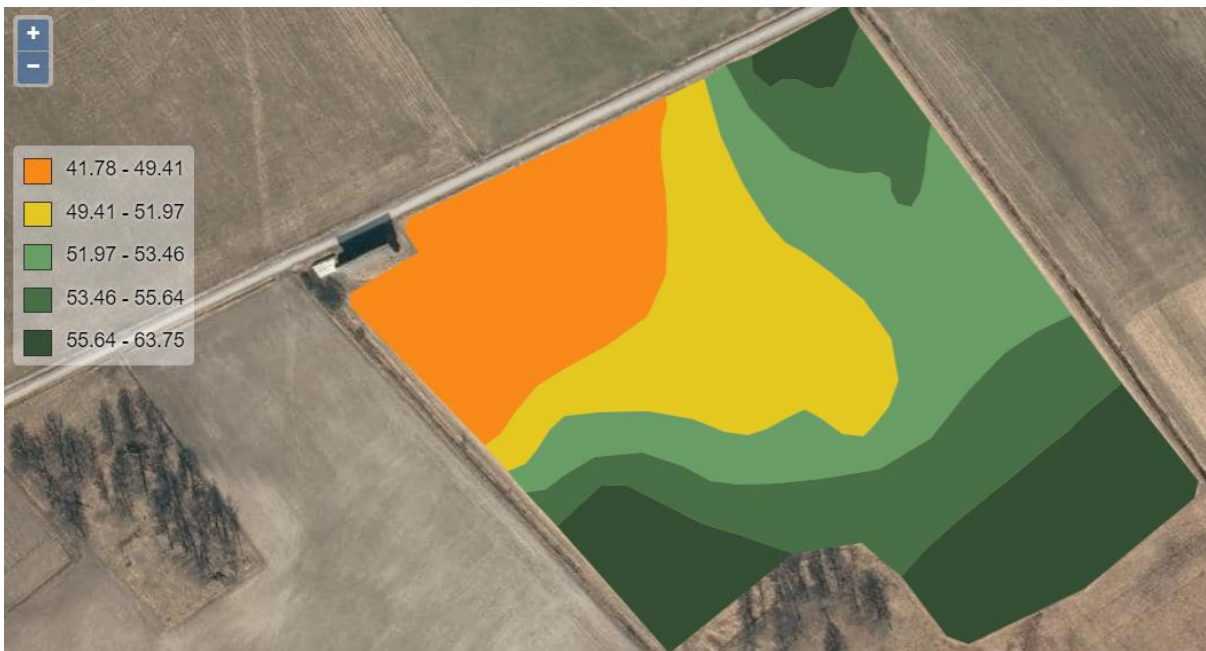
Kuva 21 Skannerin pilvipalvelun antama kosteuskartta 4.5. mitatusta alueesta (Alaniitty 1). Kuva: Antti Lajunen.
