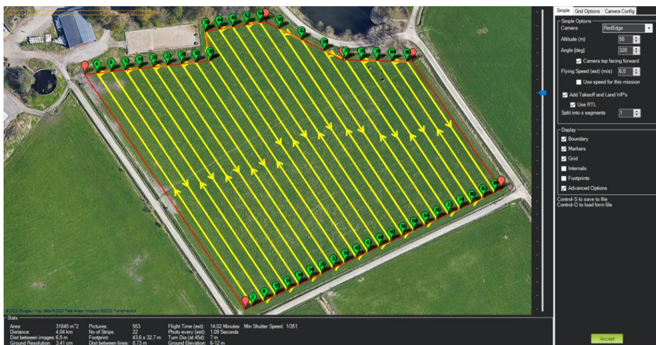
Kuva 8. Esimerkki yhdestä Mission Plannerilla suunnitellusta lentotehtävästä. Kuva: Juha Jokiniemi.
