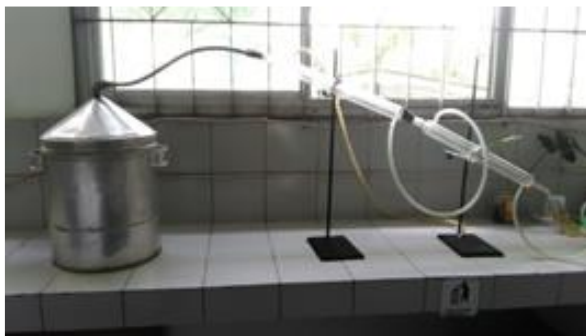
Gambar 1 Alat penyulingan (metode distilasi basah)
