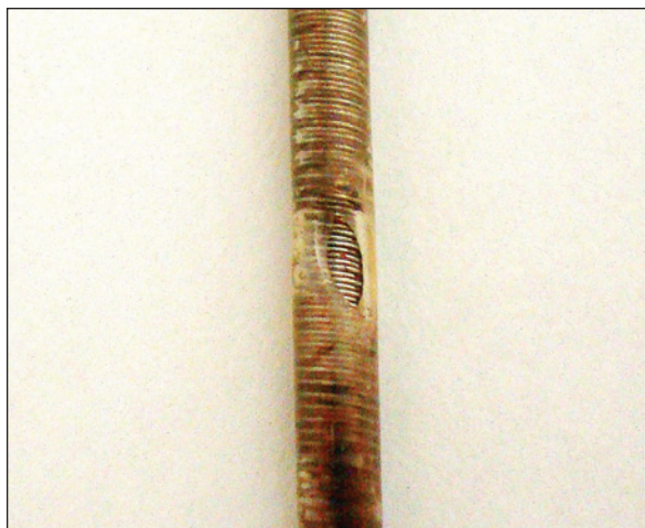
Figura 12 - Lesão do isolamento de silicone e infiltração do eletrodo ventricular.
