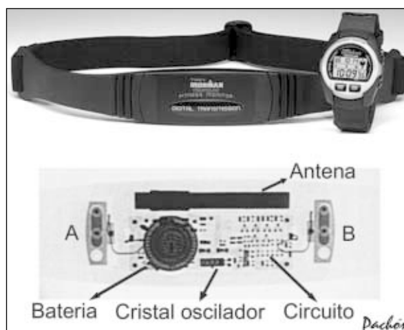
Figura 1 - Monitor de pulsos pessoal (acima). Observar o cinto detector/transmissor modelo M515 e receptor em forma de relógio modelo 51561. Não há nenhuma conexão elétrica entre os dois equipamentos. A transferência de informações ocorre através de ondas de rádio. Embaixo, imagem radiológica do transmissor, destacando-se as principais partes. A e B conectam-se aos eletrodos de borracha carbonada, que se apoiam na pele e por onde se capta o QRS.
