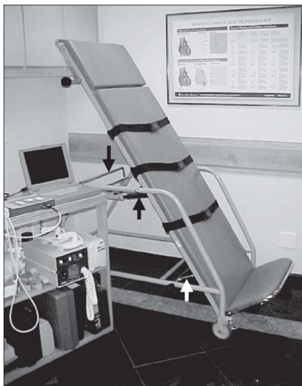
Figura 2 - Mesa inclinável para teste de inclinação projetada pelo autor. Observe a plataforma para apoio dos pés, os cintos de segurança ajustáveis, o delimitador do ângulo de inclinação ("seta branca"), o amortecedor hidráulico para suavizar os movimentos da mesa ("seta preta para cima").
