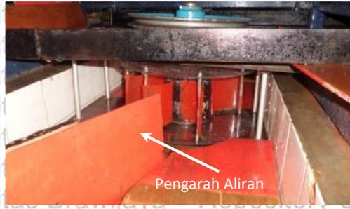
Gambar 5.5 Turbin berengsel luar dengan pengaruh aliran
