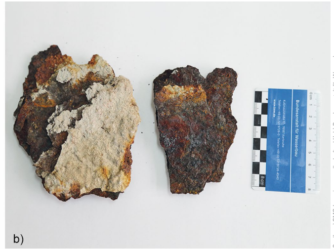
Bild 9 Blick in die Scheitelfuge: a) Gelenkplatten mit verschieden ausgeprägten Korrosionsschäden, b) Bruchstücke einer Gelenkplatte View of the apex joint: a) different degrees of joint corrosion, b) fragments of the joint
