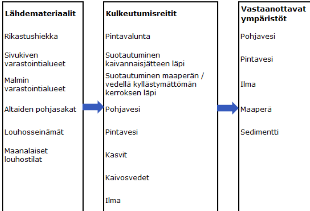
Kuva 6-1. Yleistetty konseptuaalinen malli kaivostoiminnan vesien laatuun vaikuttavista lähdemateriaaleista, kulkeutumisreiteistä ja vastaanottavan ympäristön tyypeistä. (INAP 2014)
