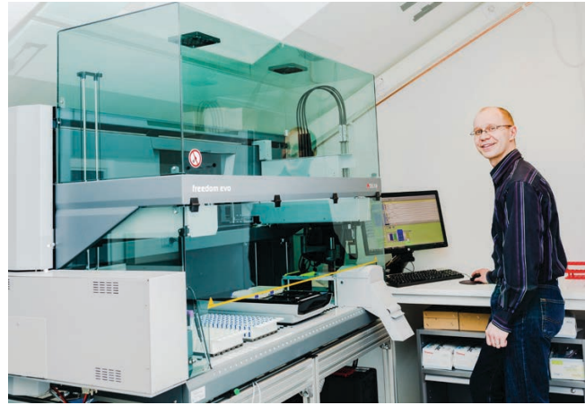
Kuva 1. Auria-biopankin näytteidenkäsittelyrobotti, jonka avulla verinäytteet jaetaan kuuteen pienempään plasmapatkeen ja neljään soluputkeen DNA-eristystä varten.
