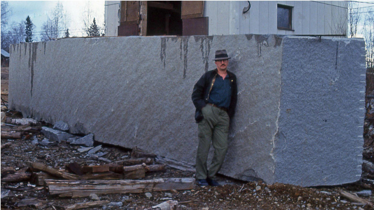
Figur 12. Valsstensämnet redo för sågning. Foto: Olavi Selonen.
