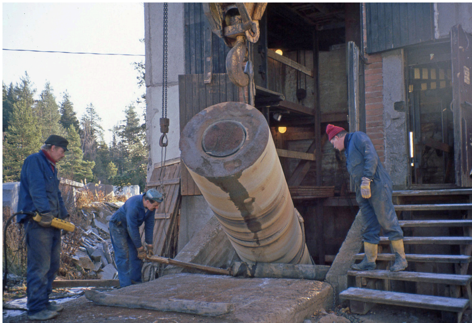
Figur 17. Den yttre diametern på valsstenen har sågats färdigt och det inre hålet halvvägs. Stenen lyfts från tornet för att vändas om. Foto: Arto Peltola.
