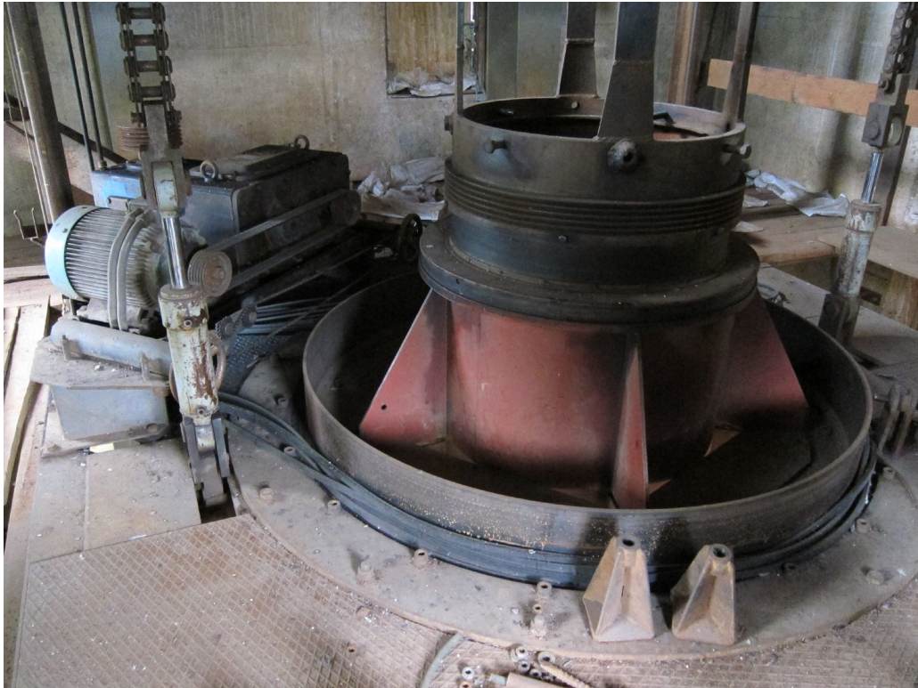
Figur 15. Roteringsmekanismen för cylindersågen. Foto: Paavo Härmä.
