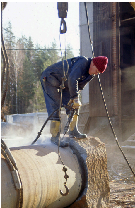
Figur 18. Styckning av valsens botten: hål borras för kilar. Foto: Arto Peltola.
