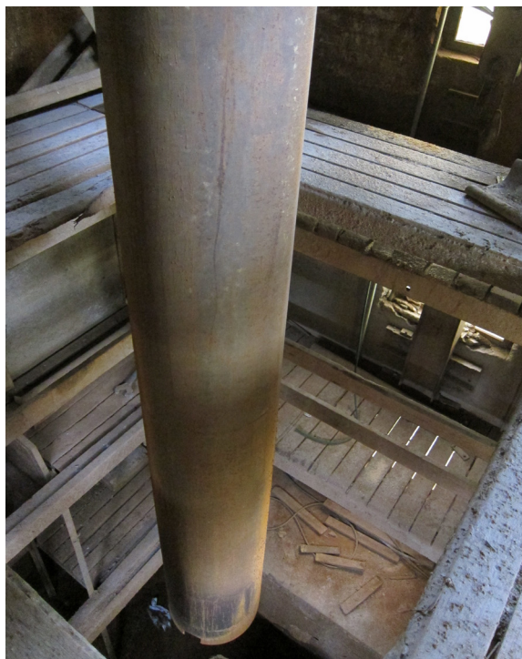
Figur 16. Cylindersågen var gjord av ett stålrör med skåror i borrstycket. Foto: Paavo Härmä.
