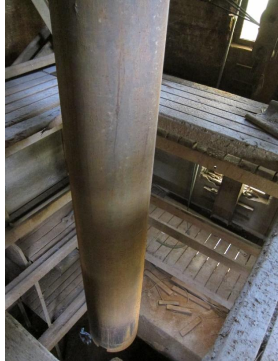
Kuva 16. Sylinterisahana käytettiin teräsputkea, jonka päähän polttoleikattiin lovia. Kuva: Paavo Härmä. Figure 16. The cylindrical saw was made from a piece of steel tube. Photo: Paavo Härmä.
