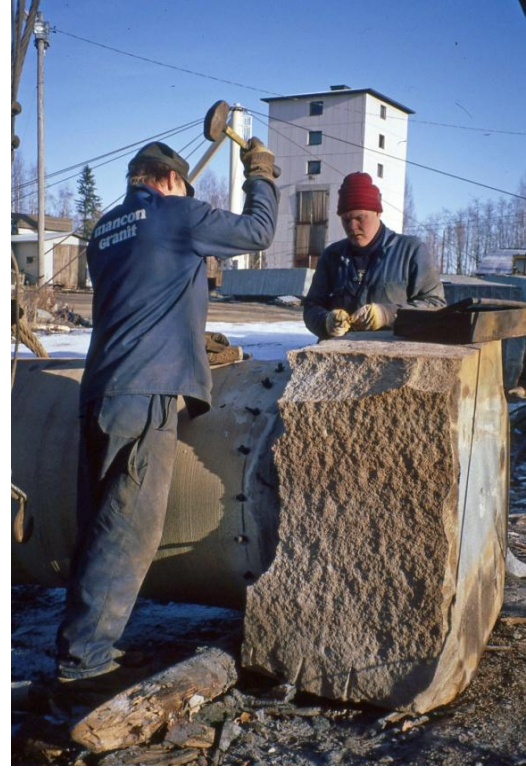
Kuva 19. Pohjan katkaisu: kiilat kiristetään taksaisesti lyömällä. Kuva: Arto Peltola.
