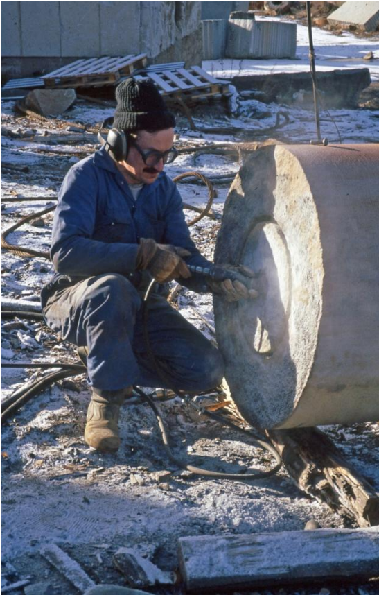
Kuva 21. Ennen kiven nostamista käännettynä takaisin valssitorniin, oli sen alapäähän tehtävä kolo, mikä keskitti aihion sitä sahattaessa. Kuva: Arto Peltola.
