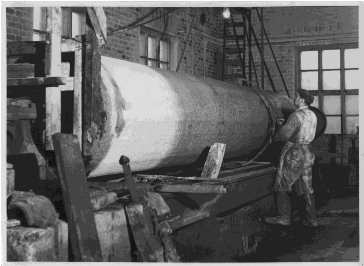
Kuva 8. Telakivien valmistusta Ab Granitin tehtaalla Salossa 1950-luvun lopulla. Kuva: Samlingen Ab Granit, Åbo Akademis bildsamlingar.
