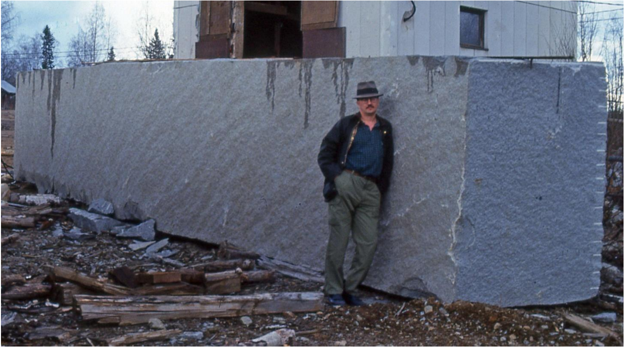
Kuva 12. Telakiviaihio valmiina sahattavaksi. Kuva: Olavi Selonen. Figure 12. A quarried block ready for dressing. Photo: Olavi Selonen.
