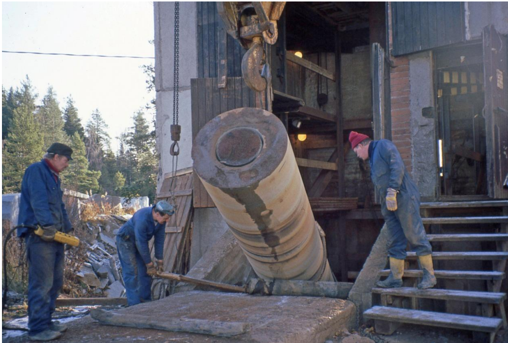
Kuva 17. Telakiven ulkopinta on sahattu tornissa kokonaan ja sisäreikä puoleenväliin saakka. Kivi nostetaan tornista kääntöä varten. Kuva: Arto Peltola. Figure 17. The outer surface of the roll has been sawed in full while the hole for the axis is sawed half way through. The stone is lifted from the mill for turning around. Photo: Arto Peltola.
