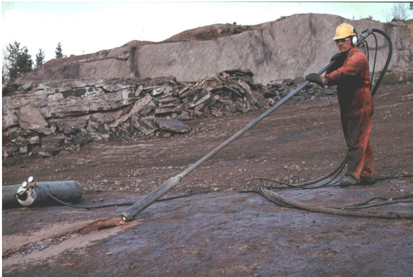
Kuva 11. Kiven polttoleikkaus. Polttoleikkauksessa paineilman ja polttoöljyn seos johdettiin polttopilliin, jossa tapahtui voimakas palaminen n. 2500 °C:n lämpötilassa. Kivi kuumentui paikallisesti ja särkyi kvartsin muodonmuutosten johdosta. Liekin synnyttämän railon leveys kivessä oli 100-150 mm. Voimakkaan melun ja pölyämisen takia menetelmä ei enää käytetä. Kuva: Veli Juhani Hänninen.
