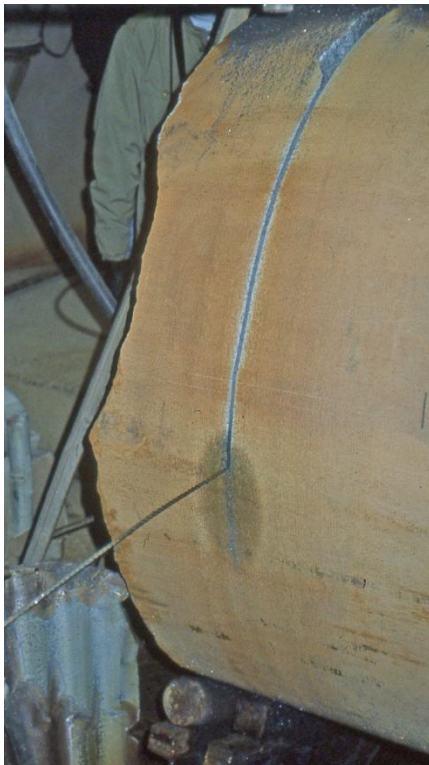
Kuva 23. TELA-aihion katkaisu vaijerisahalla sopivan mittaiseksi. Kuva: Roger Aapola. Figure 23. Cutting of the roll with wire saw. Photo: Roger Aapola.
