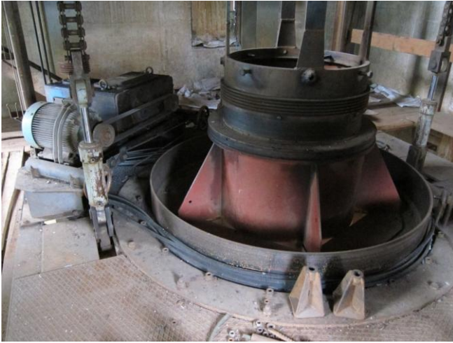
Kuva 15. Valssitornin sylinterisahan pyörityskoneisto. Kuva: Paavo Härmä. Figure 15. Rotating mechanism of the cylindrical saw. Photo: Paavo Härmä.
