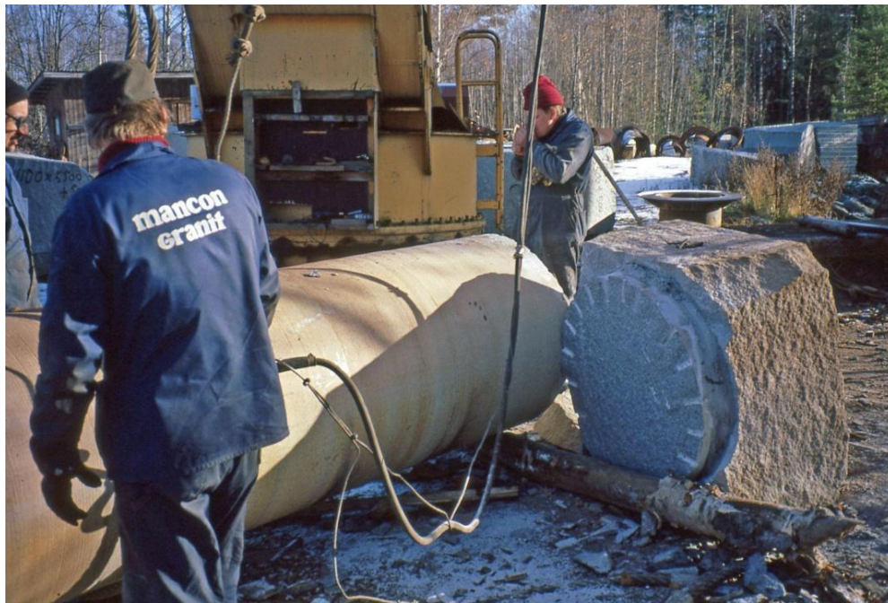
Kuva 20. Pohjan katkaisu onnistui hyvin - kivi lohkesi suoraan. Aina näin ei tapahtunut, joten työvara oli laskettu telan pituuteen 60 cm. Kuva: Arto Peltola.
