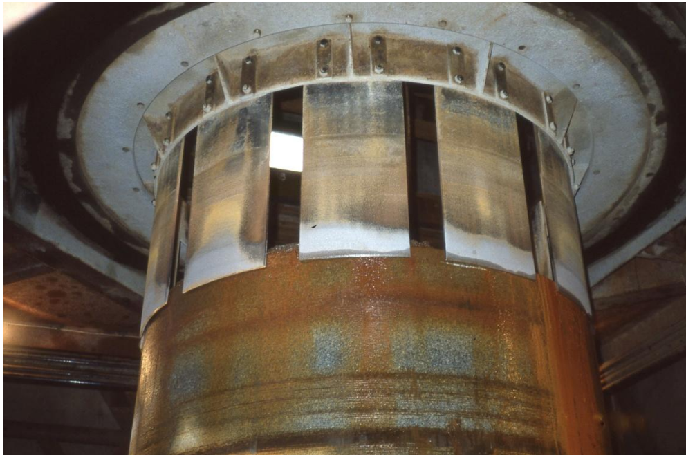
Kuva 14. Telan ulkopinta sahattiin pyörivällä sylinterisahalla. Kuva: Roger Aapola. Figure 14. The outer surface of the roll was sawed with a rotating cylindrical saw. Photo: Roger Aapola.
