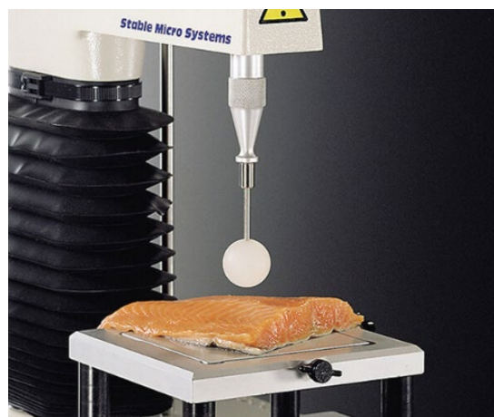
Kuva 21. Kalafileen kiinteyden mittaus palloanturilla. Kuva Stable Micro Systems:in luvalla https://www.stablemicrosystems.com/images/secondary-image/food/spherical-probe-fish.jpg
