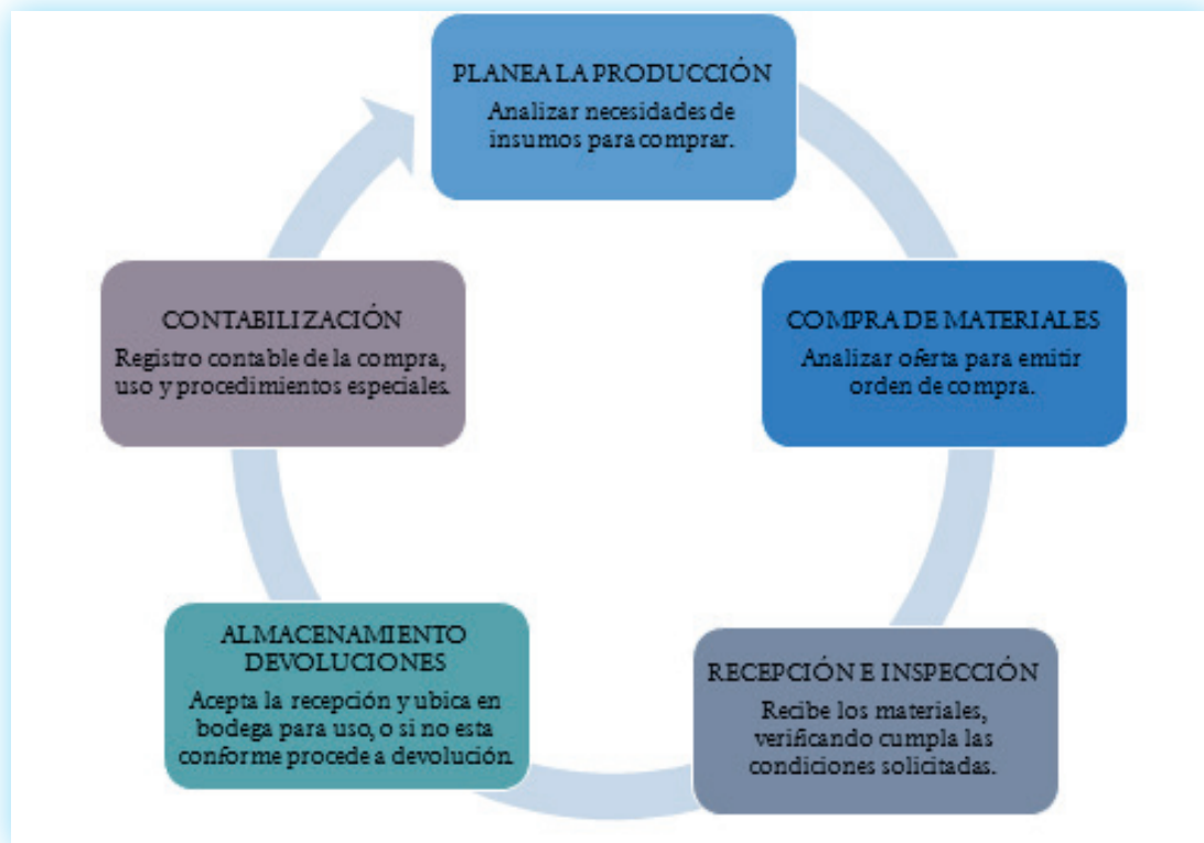
Figura 20. Fases del control de materiales.
